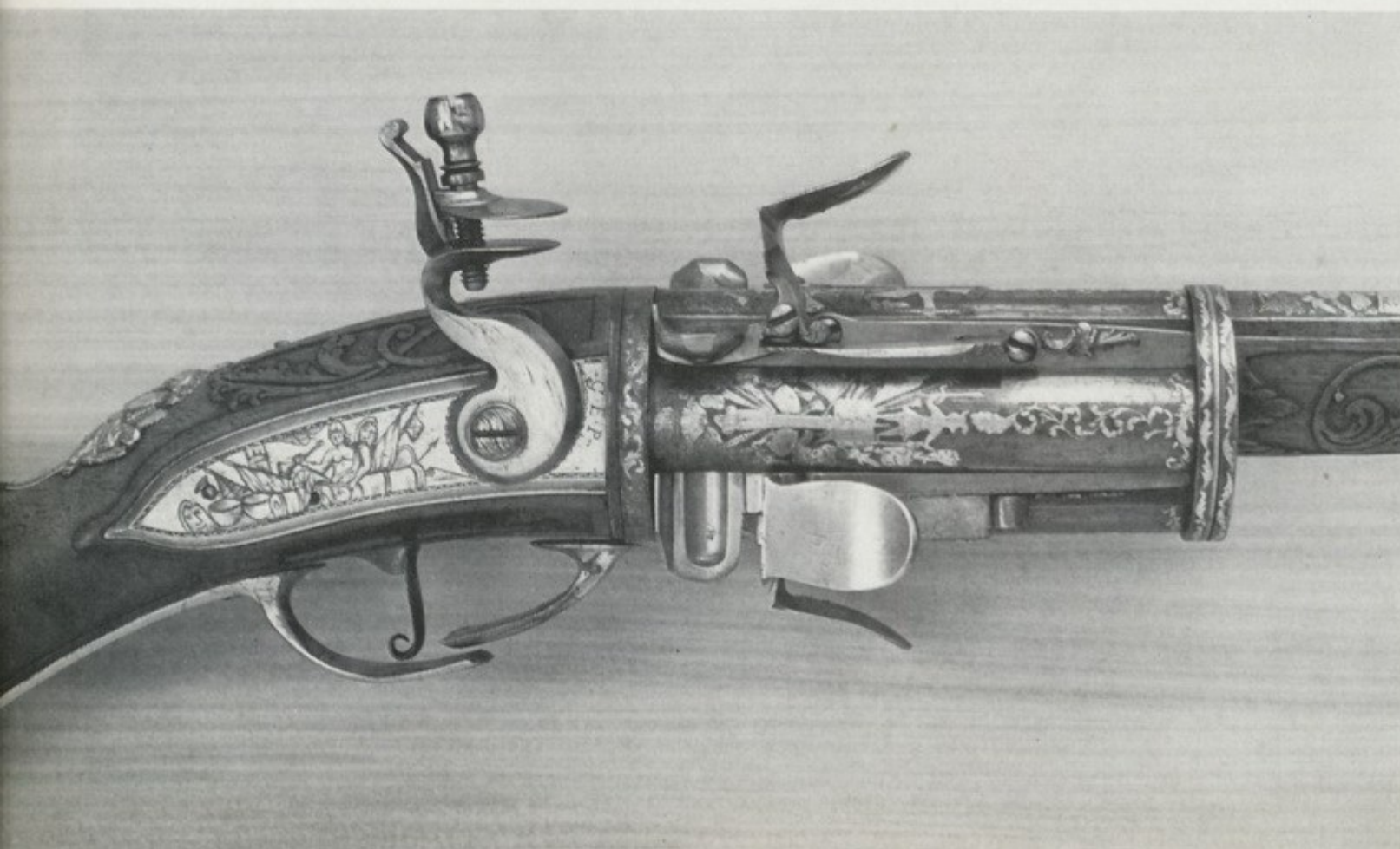
107 Doppelläufige Ganzmetall-Steinschloßpistole . Lüttich. Um 1750. «Kanonenläufe» mit acht Zügen; Kastenschlösser; eine Seite des Schloßkastens bezeichnet: «SEGALLAS», die andere «LONDON» (originalgetreuer Lütticher Nachbau). Länge 150 mm, Kaliber 9 mm
