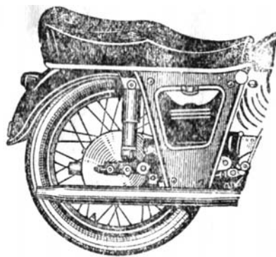
Фиг. 160. Рычажная пружинно-гидравлическая задняя подвеска мотоцикла ИЖ-56:
