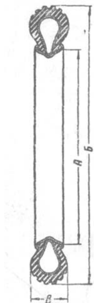
Фиг. 167. Монтажные размеры покрышек.
