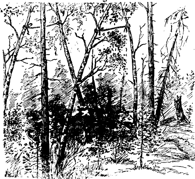
Рис. 55. Маскировка танка стягиванием верхушек деревьев
