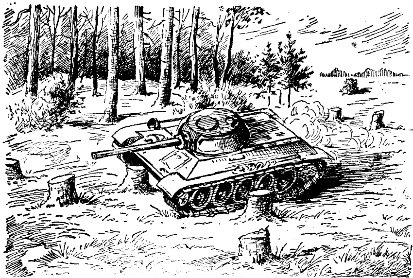
Рис. 107. Преодоление пней, по высоте превышающих клиренс танка
