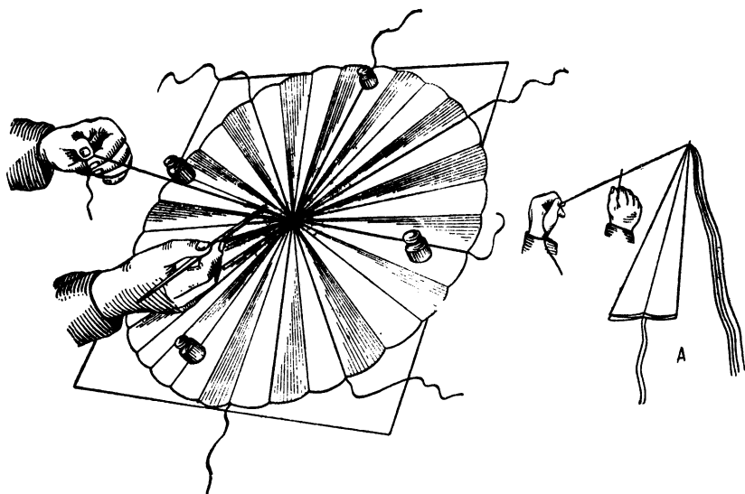
Фиг. 53. Приклейка строп к куполу: А—другой способ приклейки строп.
