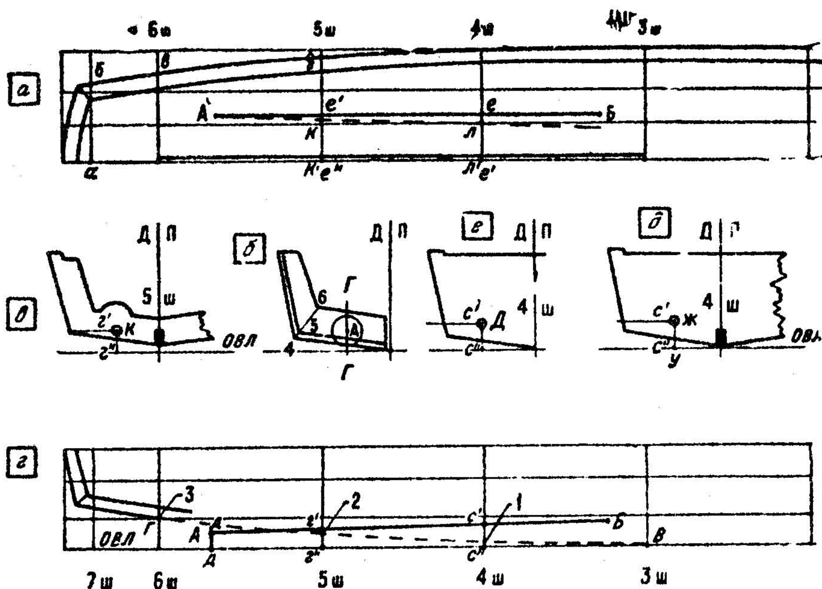
Рис. 35. Разметка дейдвудных трубок и шпангоутов
