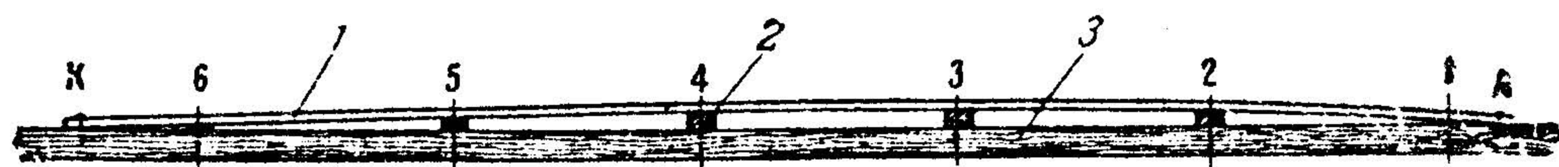
Рис. 32. Крепление настила палубы: 1 — настил палубы; 2 — стапельные бруски; 3 — стапельная доска
