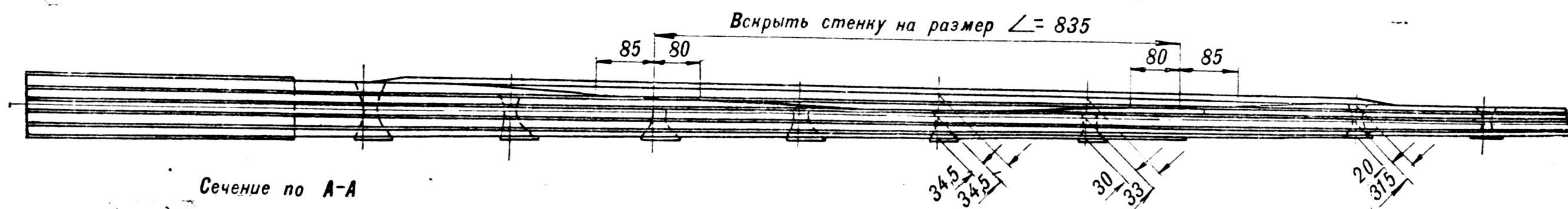
Типовое соединение стенок на ус \angle = 10 h
