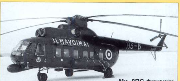
Ми-8ПС финских ВВС, оборудованный метеолокатором
