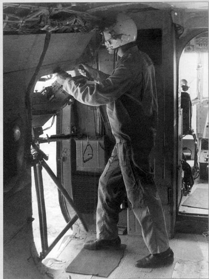
«Афганские» доработки Ми-8МТ: пулемет ПКТ в хвостовом люке, гранатомет АГС-17 «Пламя», крупнокалиберный пулемет НСВ-12,7 «Утес» в грузовой кабине
