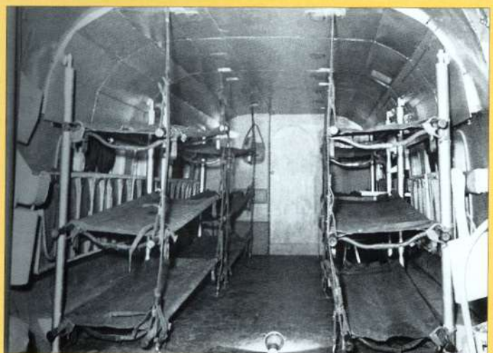
Варианты загрузки вертолета опробовались на макете
