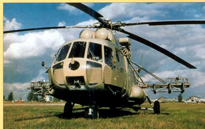
«Афганские» доработки Ми-8МТ: усиленное вооружение, дополнительное бронирование и носовая турель с пулеметом ПКТ
