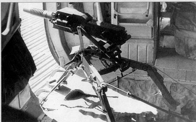
«Афганские» доработки Ми-8МТ: пулемет ПКТ в хвостовом люке, гранатомет АГС-17 «Пламя», крупнокалиберный пулемет НСВ-12,7 «Утес» в грузовой кабине
