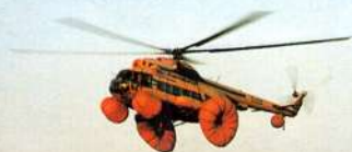
Опытный вертолет Ми-8МТВ с французской системой аварийного приводнения
