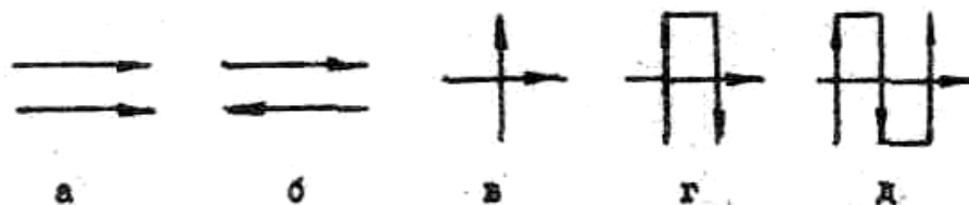
Рис. 1.8 Схема движения воздуха и газа в регенератора: а - прямоток, б - противоток; в - одноходовой перекрестный ток; г - двухходовой перекрестный ток; д - трехходовой перекрестный ток.
