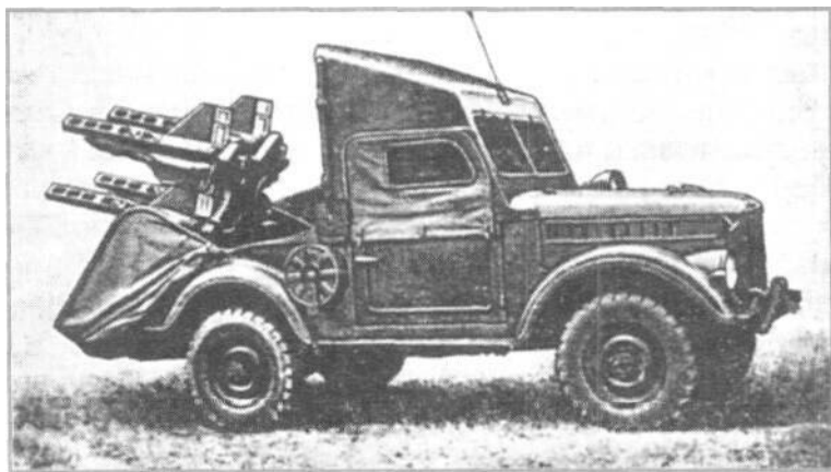
Боевая машина 2П26 с ракетами 3М6 комплекса «Шмель» в боевом положении
