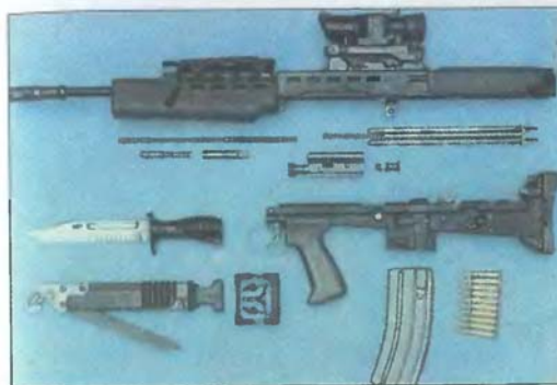
Неполная разборка винтовки L85A1 (Великобритания)
