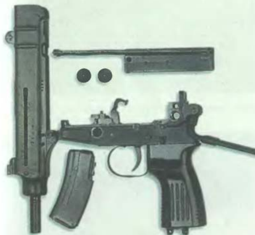
Неполная разборка пистолета-пулемета «Скорпион» Vz.61 (Чехословакия)
