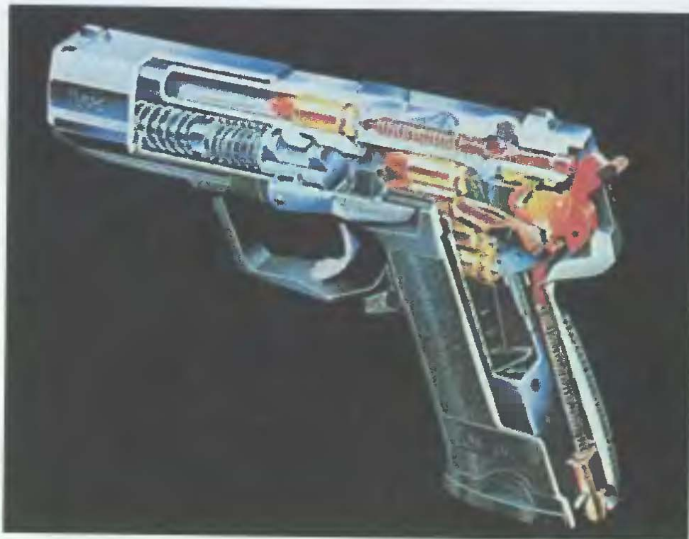
Схема устройства пистолета USP (ФПГ) — одна из оригинальных систем последнего десятилетия XX века
