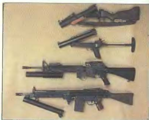
40-мм противотанковые гранатометы в наложенных для заряжания: M79, HK69A1, M203, HK79
