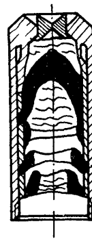
«Пулеулавливатель» после выстрела. Пуля остановлена последней перегородкой
