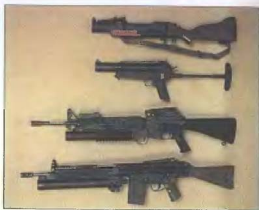
40-мм противотанковые гранатометы разных схем: ручные M79 (США) и HK69A1 (ФРГ), подствольные M203 (на винтовке M16A1, США) и HK79 (на винтовке G3, ФРГ)
