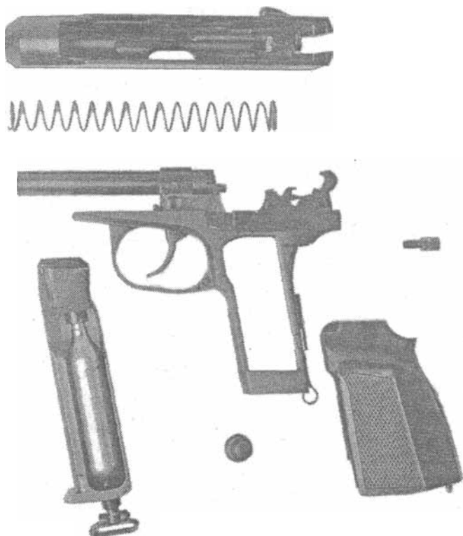
Неполная разборка пистолета МР-654К
