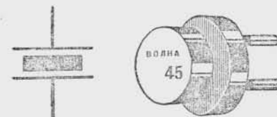
Рис. 250. Обозначение кварцевой пластинки в схемах и вид простейшего кварцедержателя.
