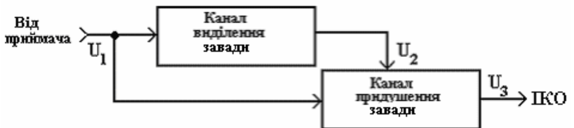
Рис. 9.7. Структурна схема пристрою захисту від НІЗ
