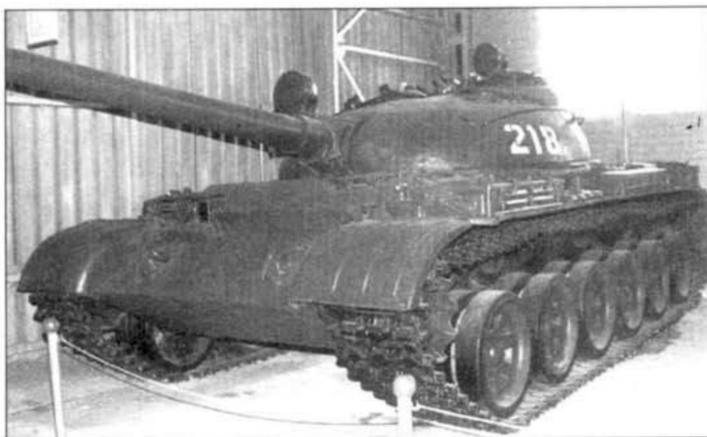
Опытный средний танк «Объект 167». Хорошо видна новая ходовая часть с катками малого диаметра и поддерживающими роликами.
