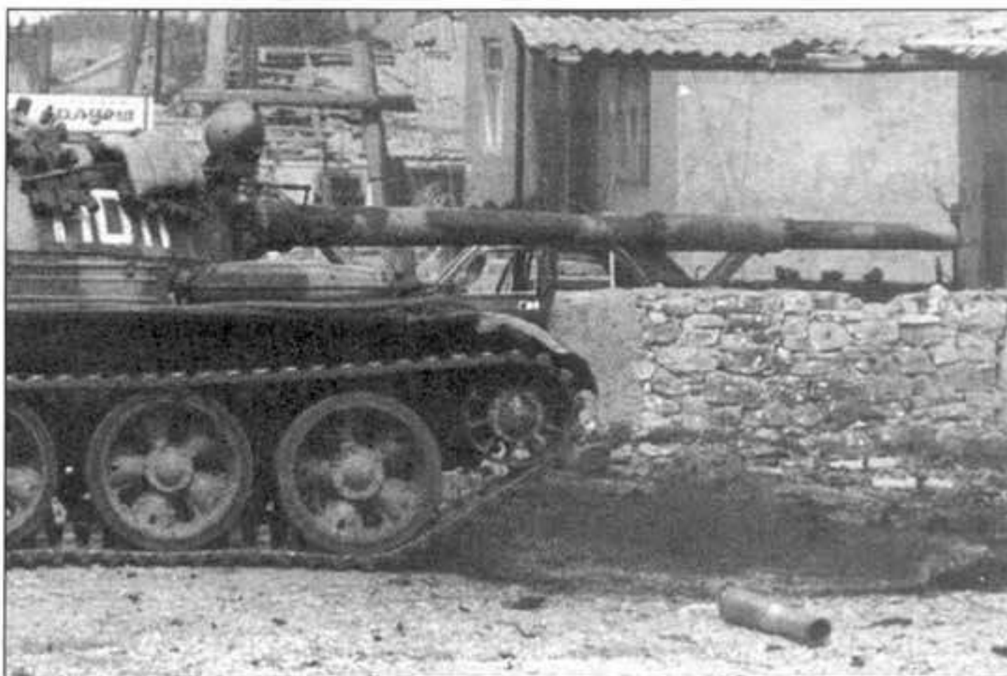
Т-62 в Карамахи (Дагестан, 2001 г.) ведет огонь по чеченским боевикам. На башне в качестве дополнительной защиты от противотанковых гранатометов укреплены запасные траки и даже туюфак.
