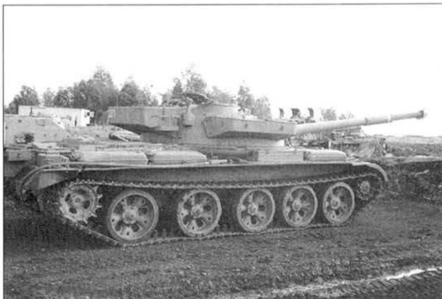
Танк «Tiran 6». Хорошо видны дополнительные ящики установленные на башне и держатель радиоантенны американского типа.
