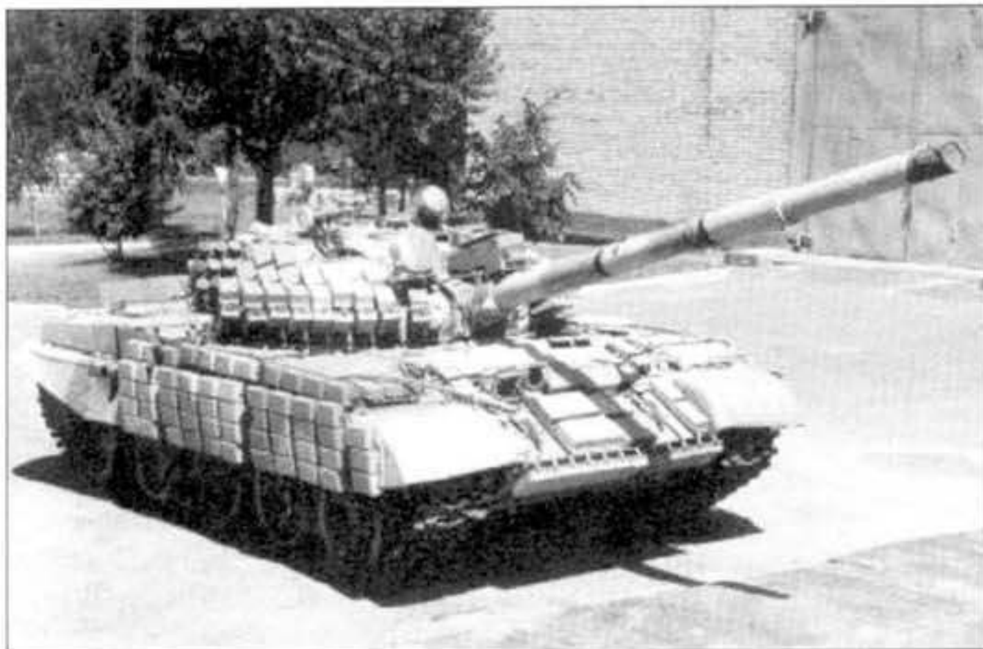
Средний танк Т-62МВ с навесной динамической защитой.
