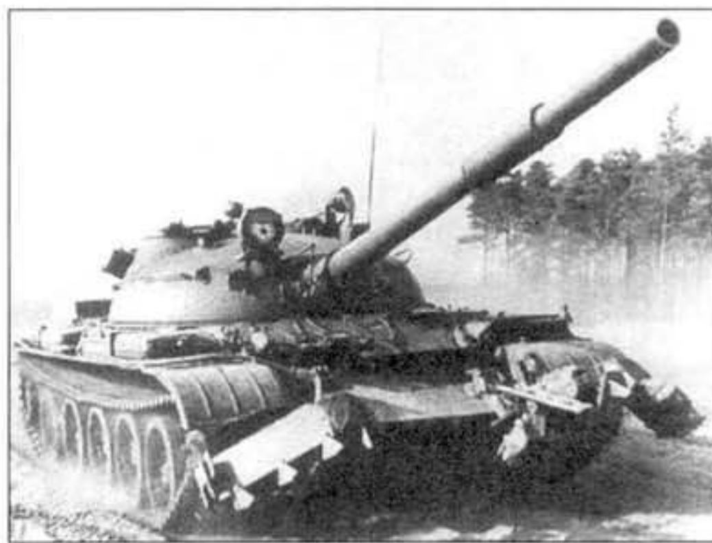
Т-62 (выпуска после 1967 г.) гвардейской танковой части с установленным колеиным минным трапом КМТ-4.
