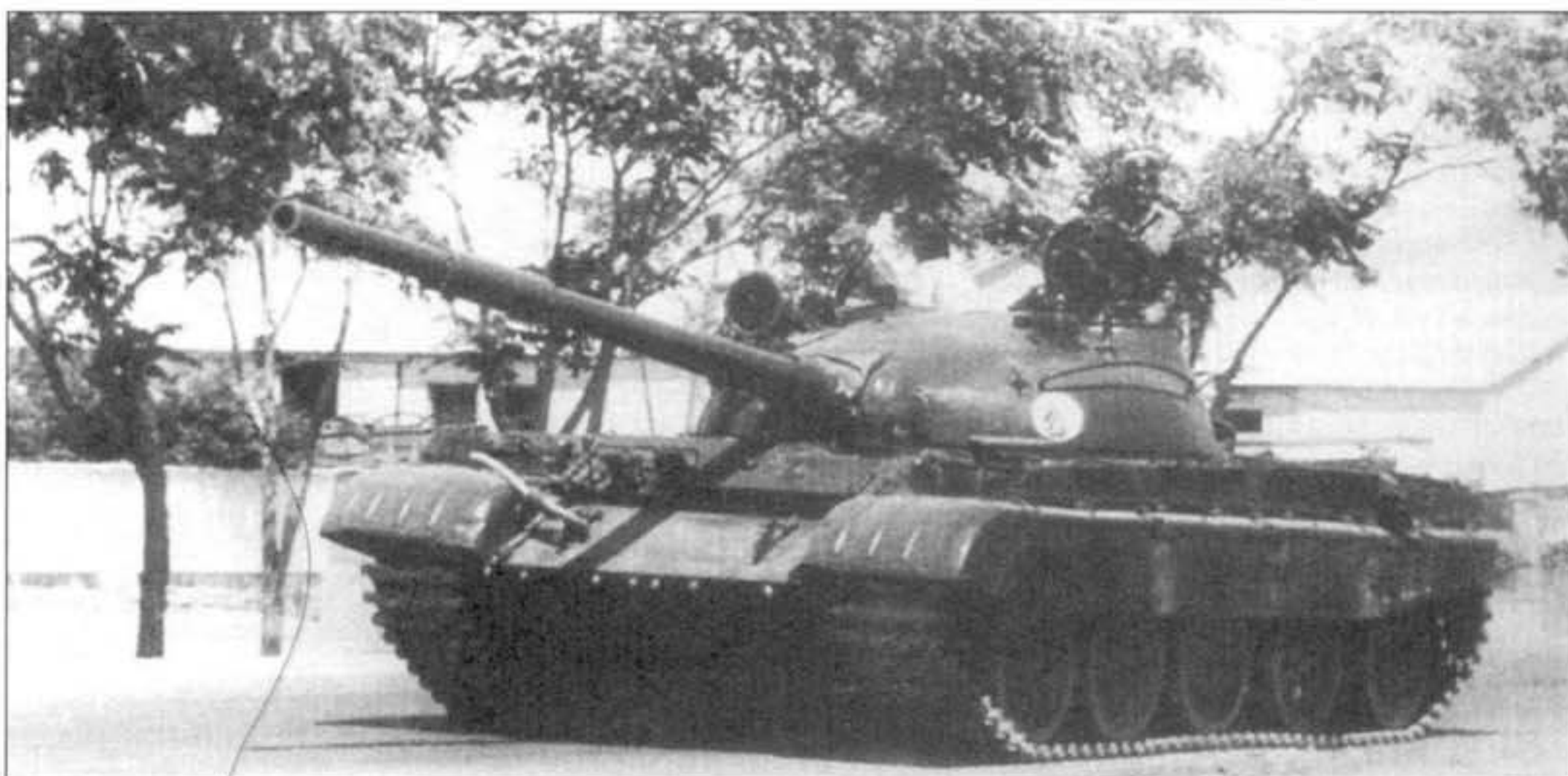
Танк Т-62 (обр. 1962 г.) армии ДРА. На этой машине установлены бортовые резиноканевые экраны (очевидно, после ремонта).
