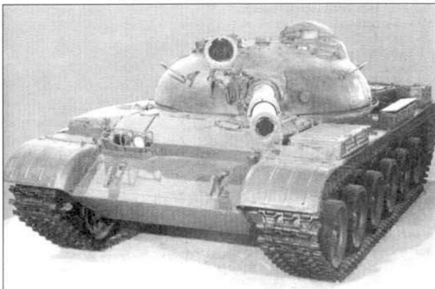
Опытный средний танк «объект 167Т» с ГТД.
