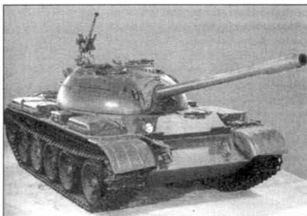
Средний танк Т-54А, вооруженный 100-мм нарезной пушкой Д-10Т.
