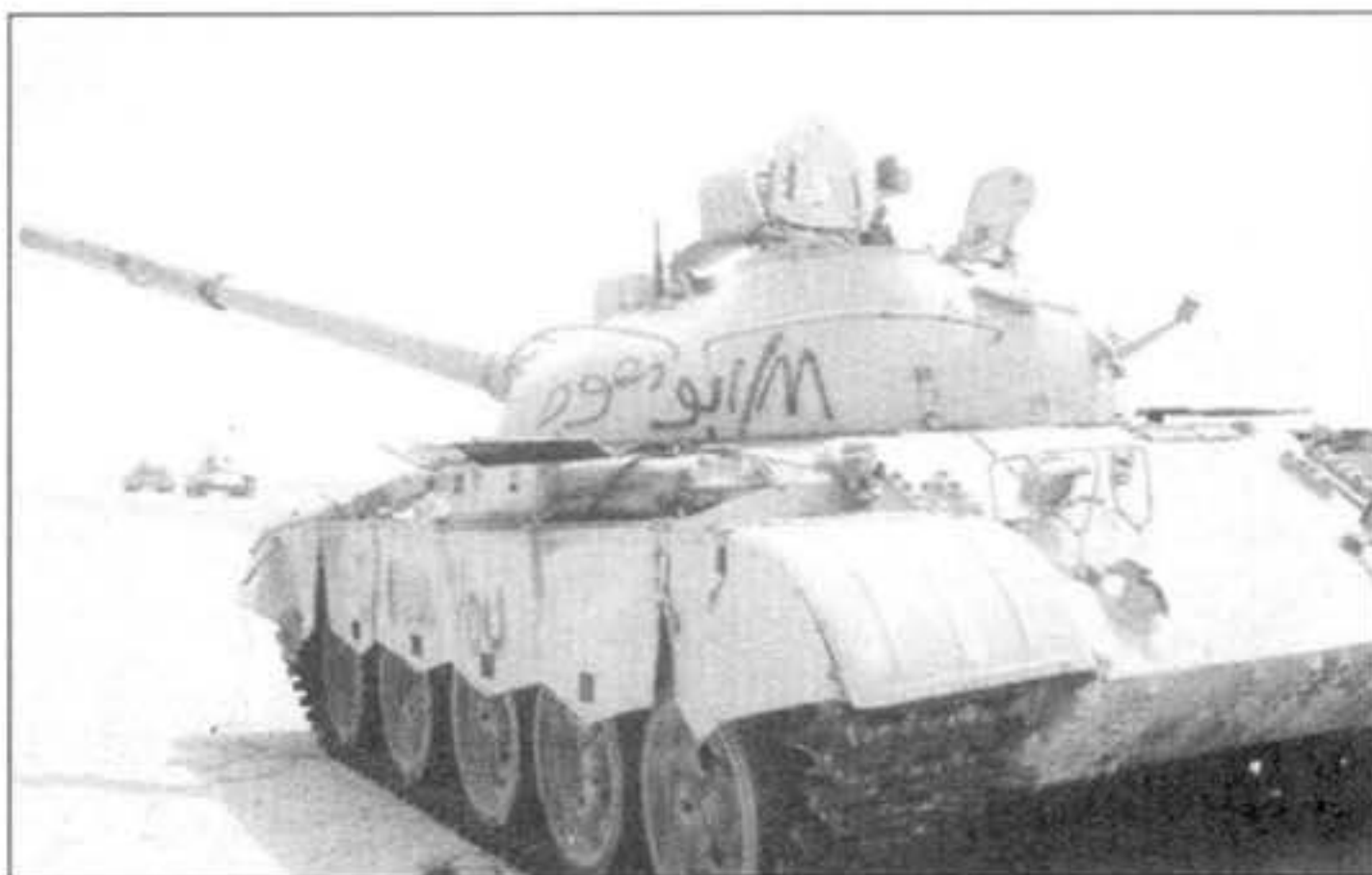
Брошенный в районе Рас Танура в 1990 г. иракский Т-62. На машине установлены бортовые экраны китайского образца.
