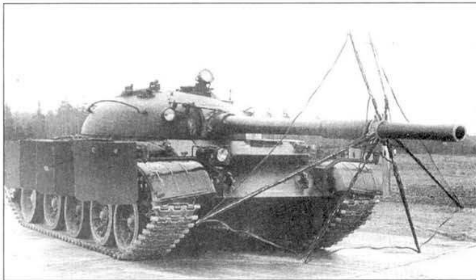
Танк Т-62 оборудованный комплексной противоккумулятивной экранной защитой (боевое положение).
