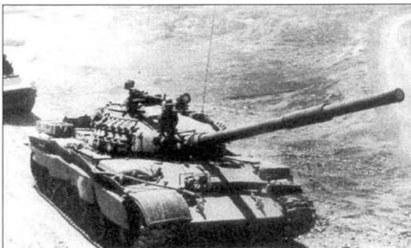
Т-62 (поздних выпусков) Советской армии в Афганистане. Для дополнительной защиты от гранат РПГ-7 на танке установлены бортовые экраны а, на башне укреплены гусеничные траки.
