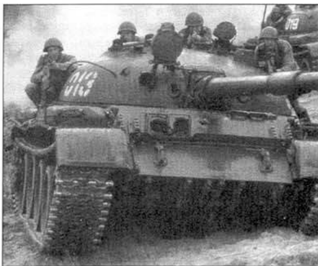
Танки Т-62 Советской армии на учениях - атакуют с десантом на броне. Хорошо видна характерная куполообразная форма башни.
