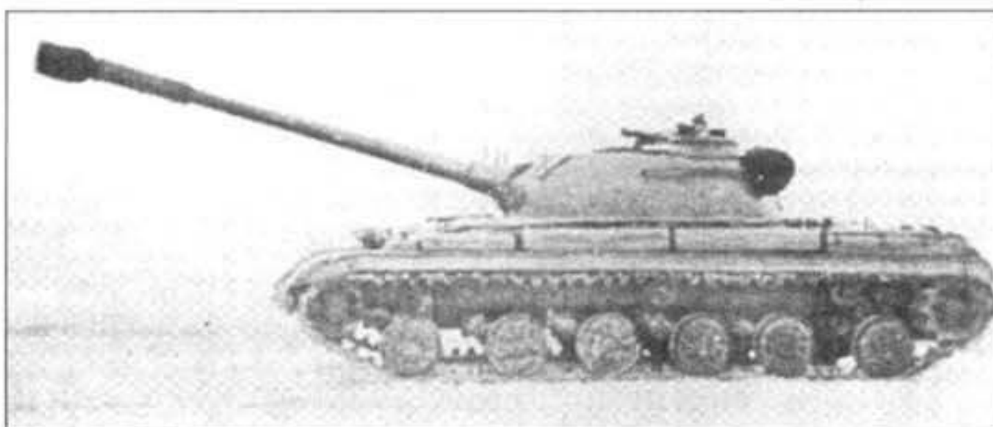
«Объект 430» на испытаниях. Машина проходила их без крупнокалиберной зенитно-пулеметной установки с КПВТ.
