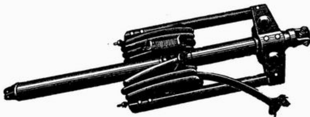
Рис. 238. Амортизационная нога шасси
