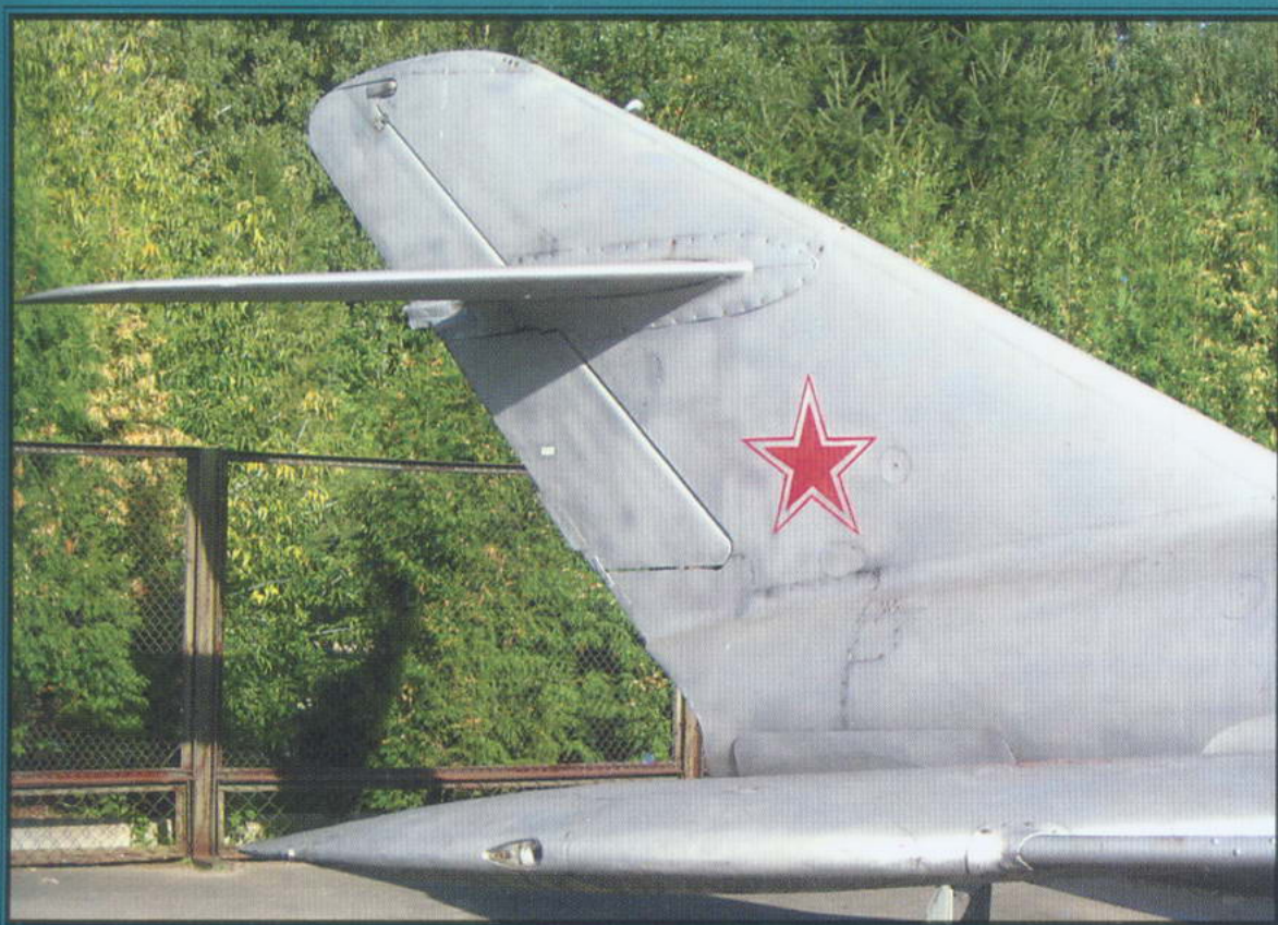
Хвостовое оперение и законцовка правого крыла
