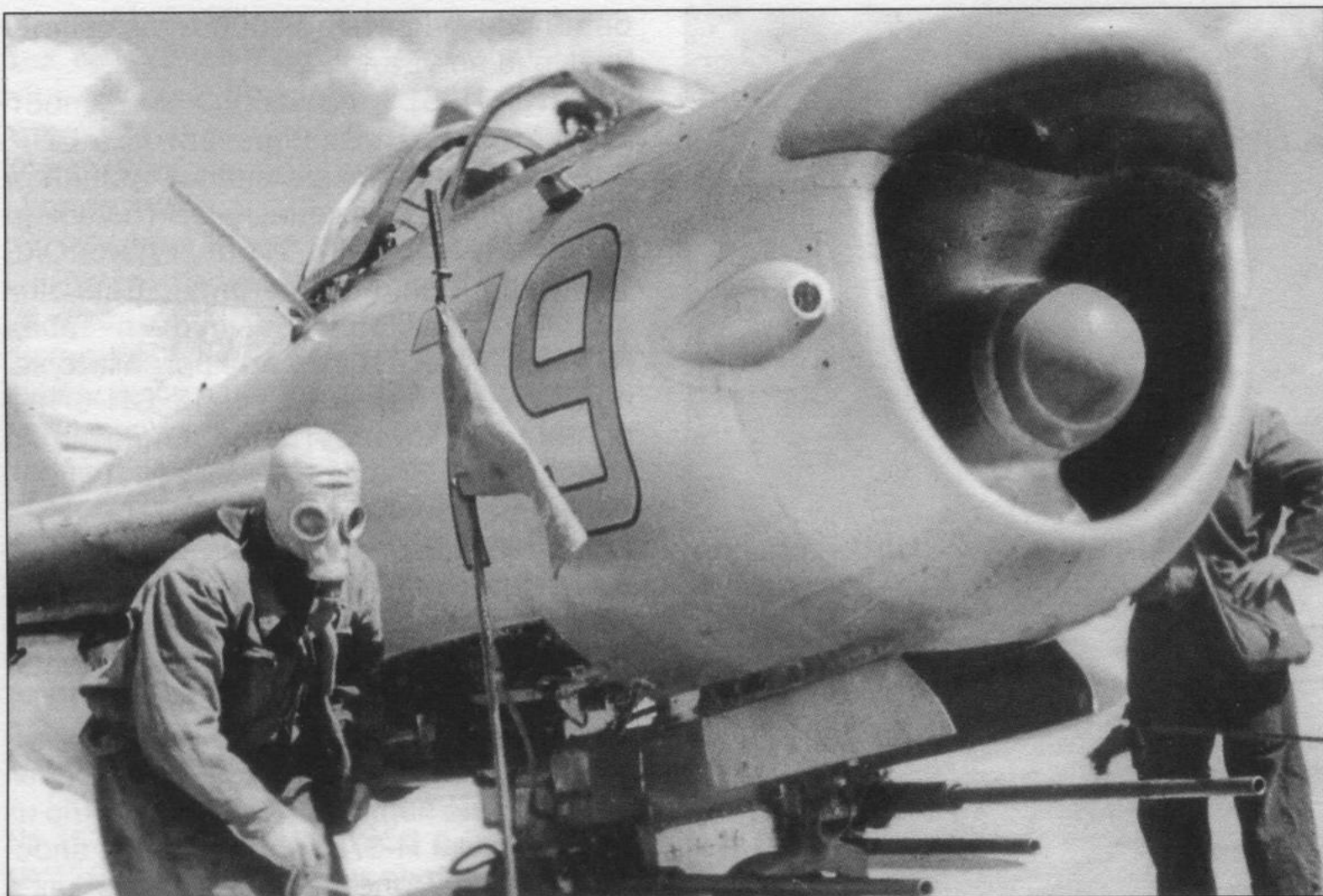
Учебная дезактивация перехватчика МиГ-17ПФ; виден опущенный лафет с пушками
