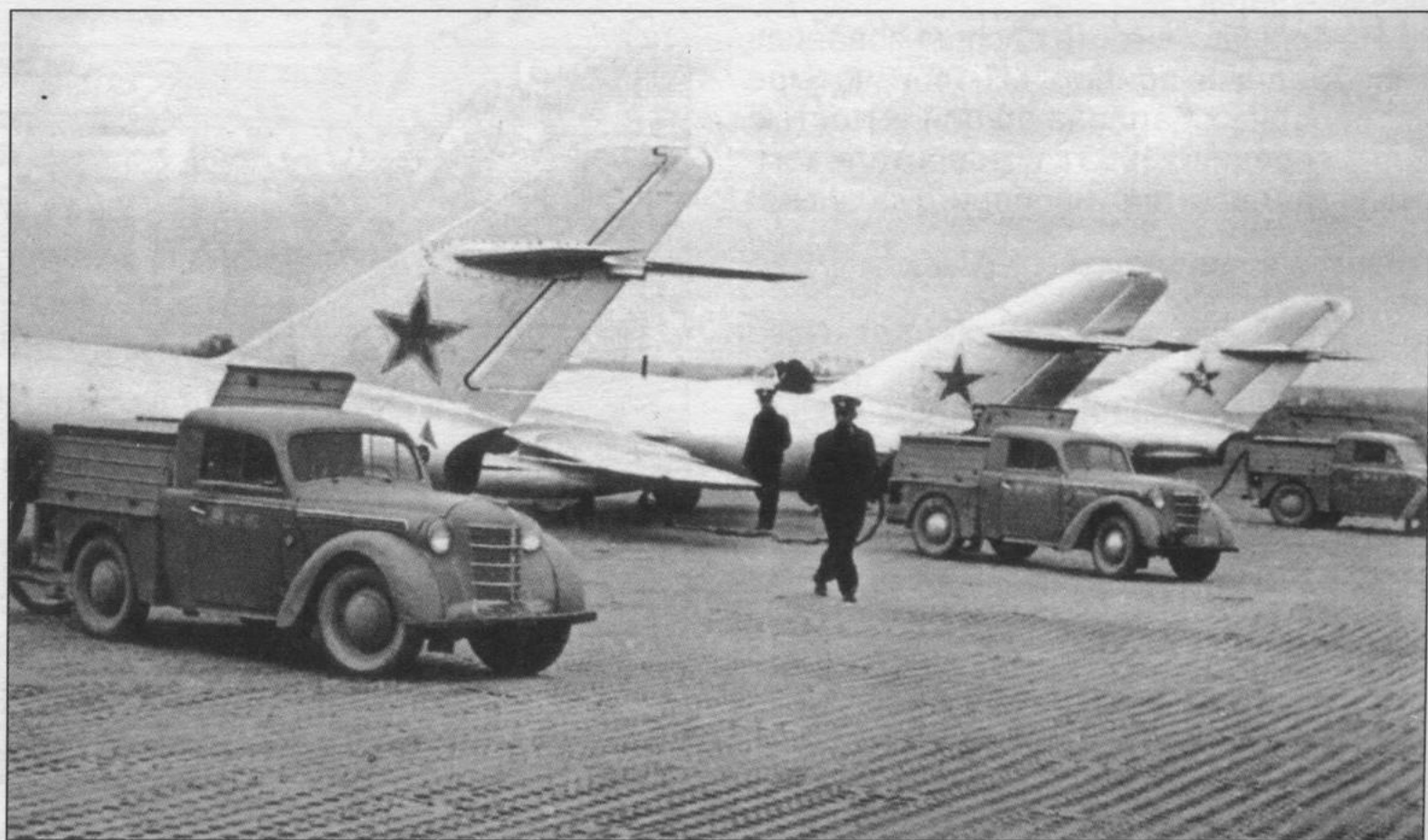
Подготовка МиГ-17 к вылету: у самолетов стоят спецмашины АПА-7 на шасси «Москвич-401»
