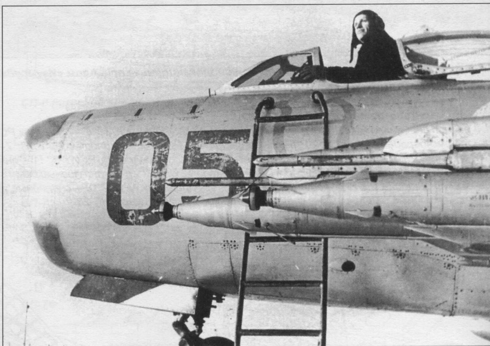
Перехватчик МиГ-17ПФУ, вооруженный ракетами РС-1-У
