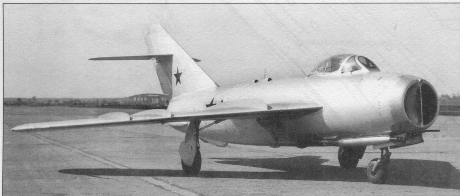
СМ-1 (И-340) с двумя двигателями АМ-5—предшественник МиГ-19
