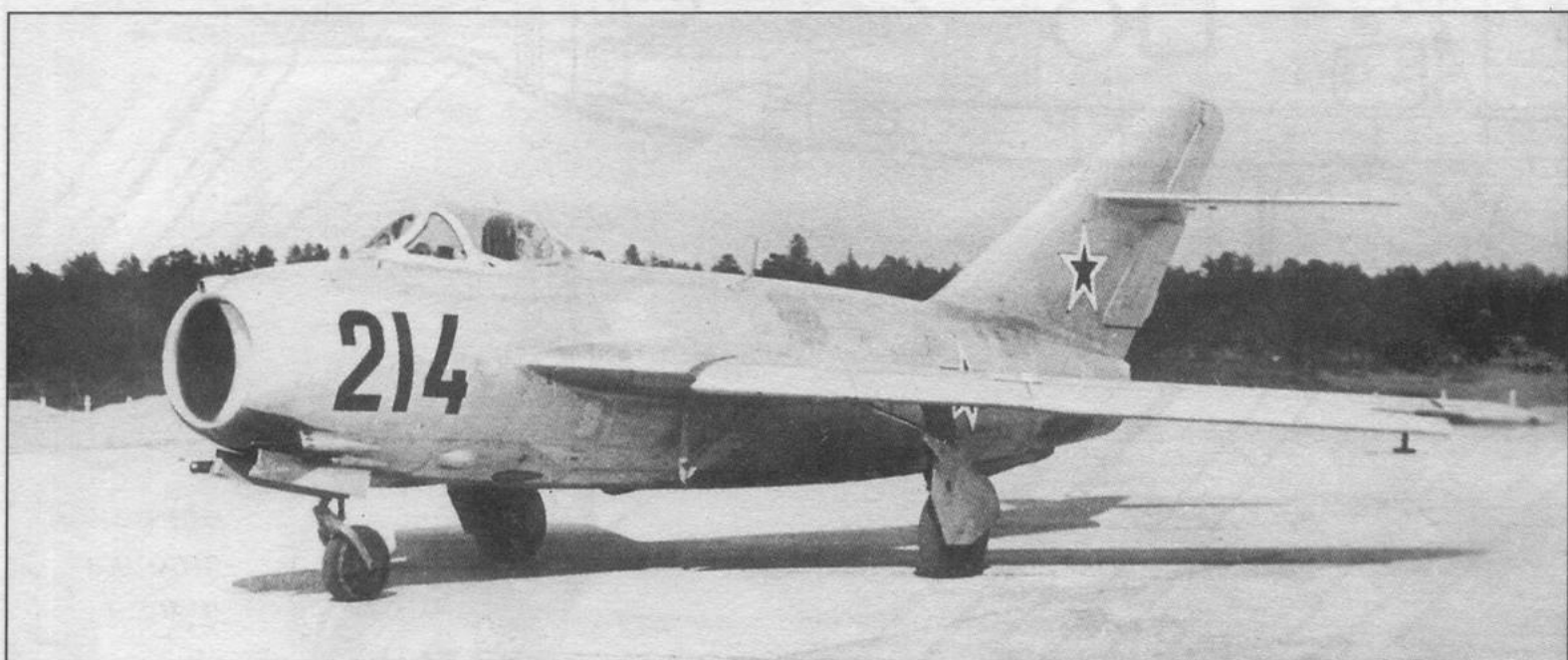
Самолет СИ-10 с цельноповоротным горизонтальным оперением
