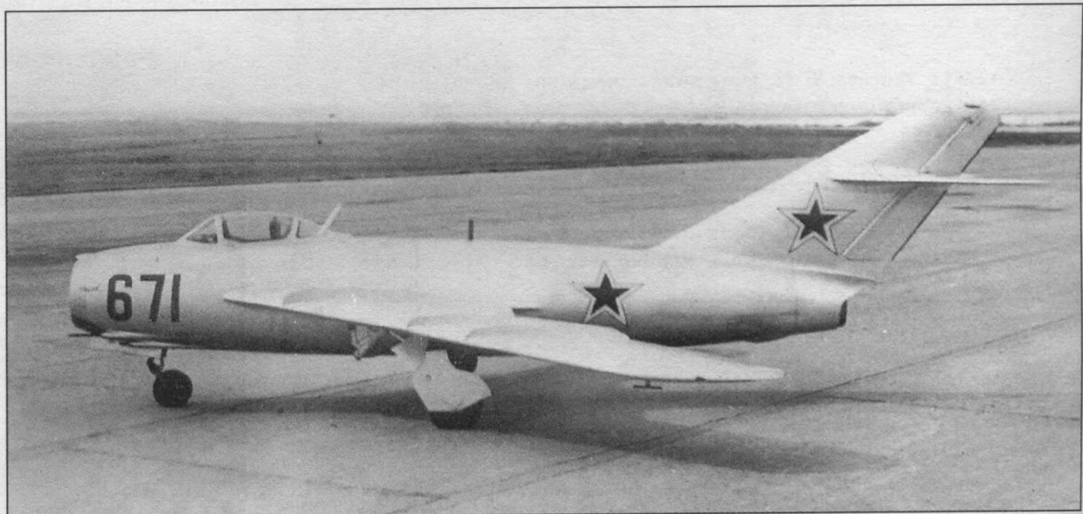
МиГ-15бис45 (И-330) — прототип будущего МиГ-17
