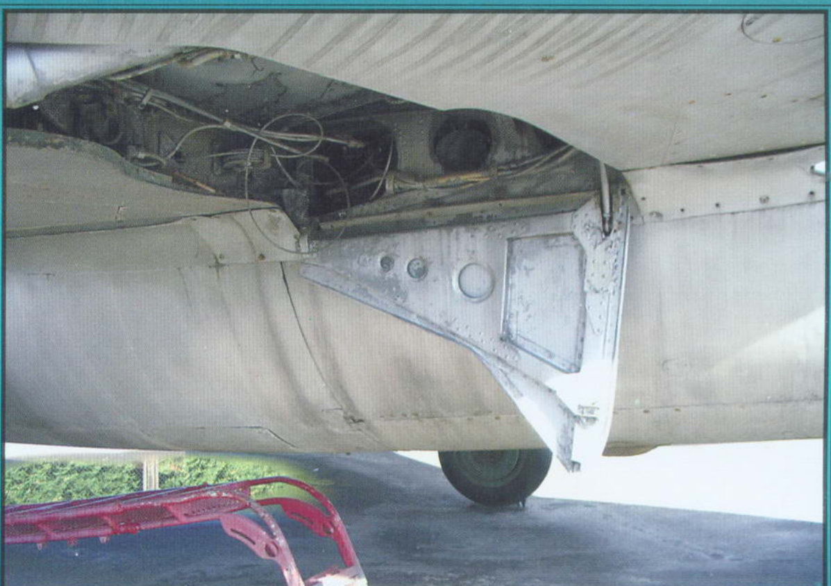
Ниша основной стойки шасси и щиток на фюзеляже
