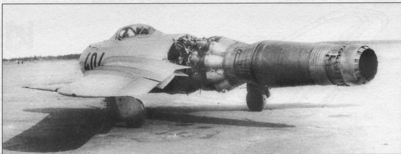
CP-2, так же как и другие варианты МиГ-17, имел технологический разъем в средней части фюзеляжа, упрощавший доступ к двигателю
