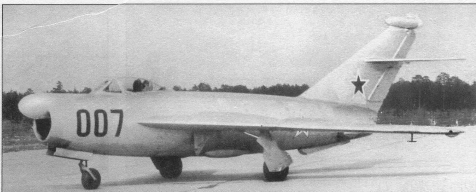
Самолет СДК-5, на котором испытывали систему наведения крылатой ракеты
