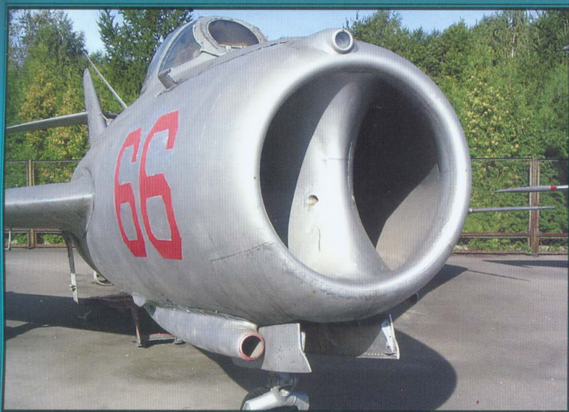
Носовая часть самолета: хорошо видны воздухозаборник ТРД с центральной перегородкой и гнездо фотокинопулемета над ним. Вооружение на истребителе отсутствует
