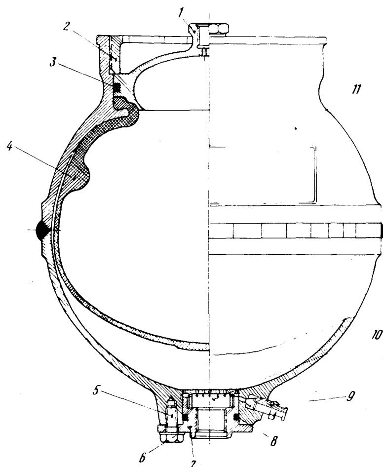
Гидроаккумулятор тормозной системы
