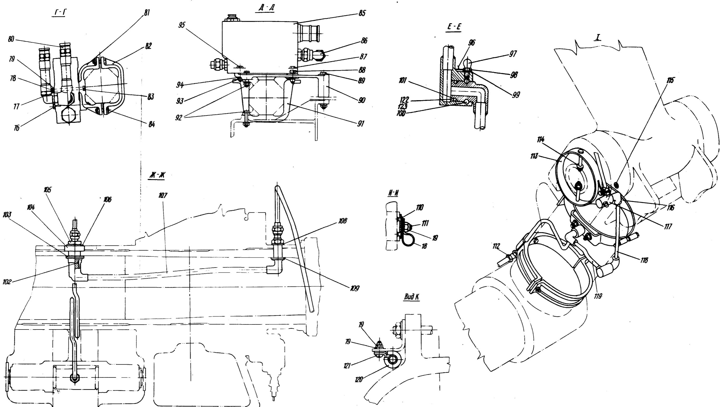
Проводка трубопроводов к цилиндуру поворота носового масси
