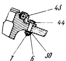
Управление поворотом колес носовой ноги шасси
