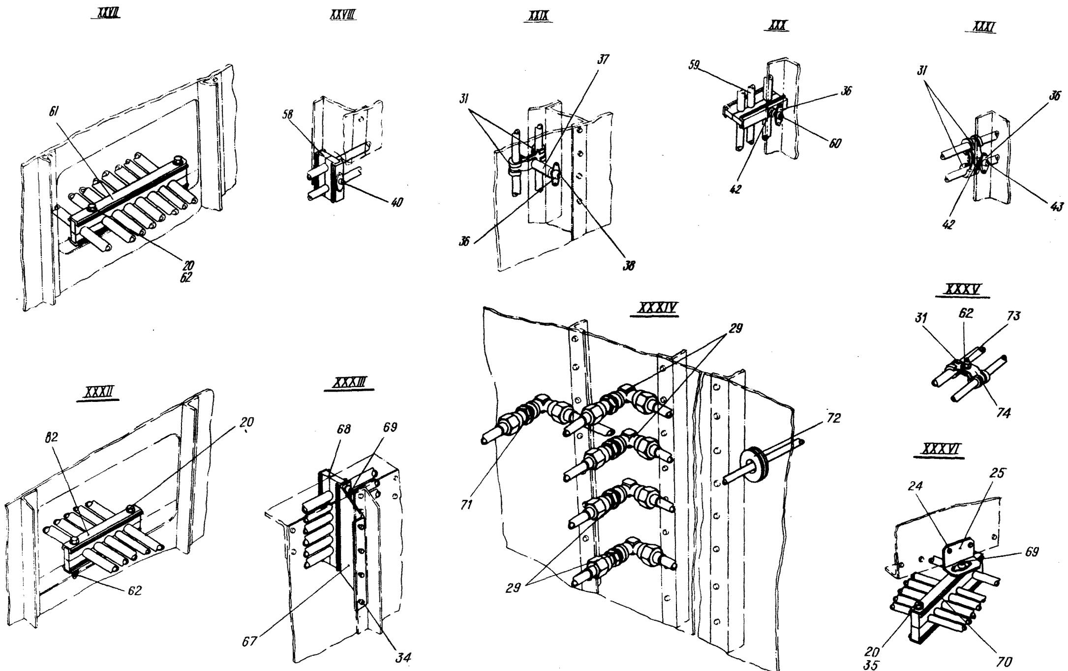
Гидросистема в отсеке носовой ноги шасси
