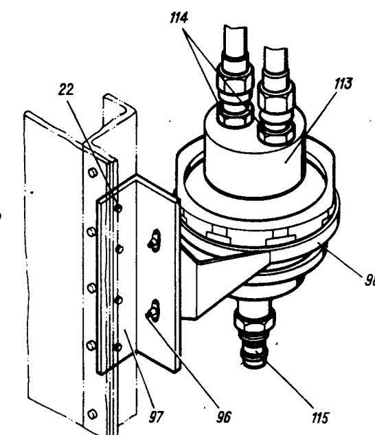
Гидросистема в отсеке носовой ноги шасси
