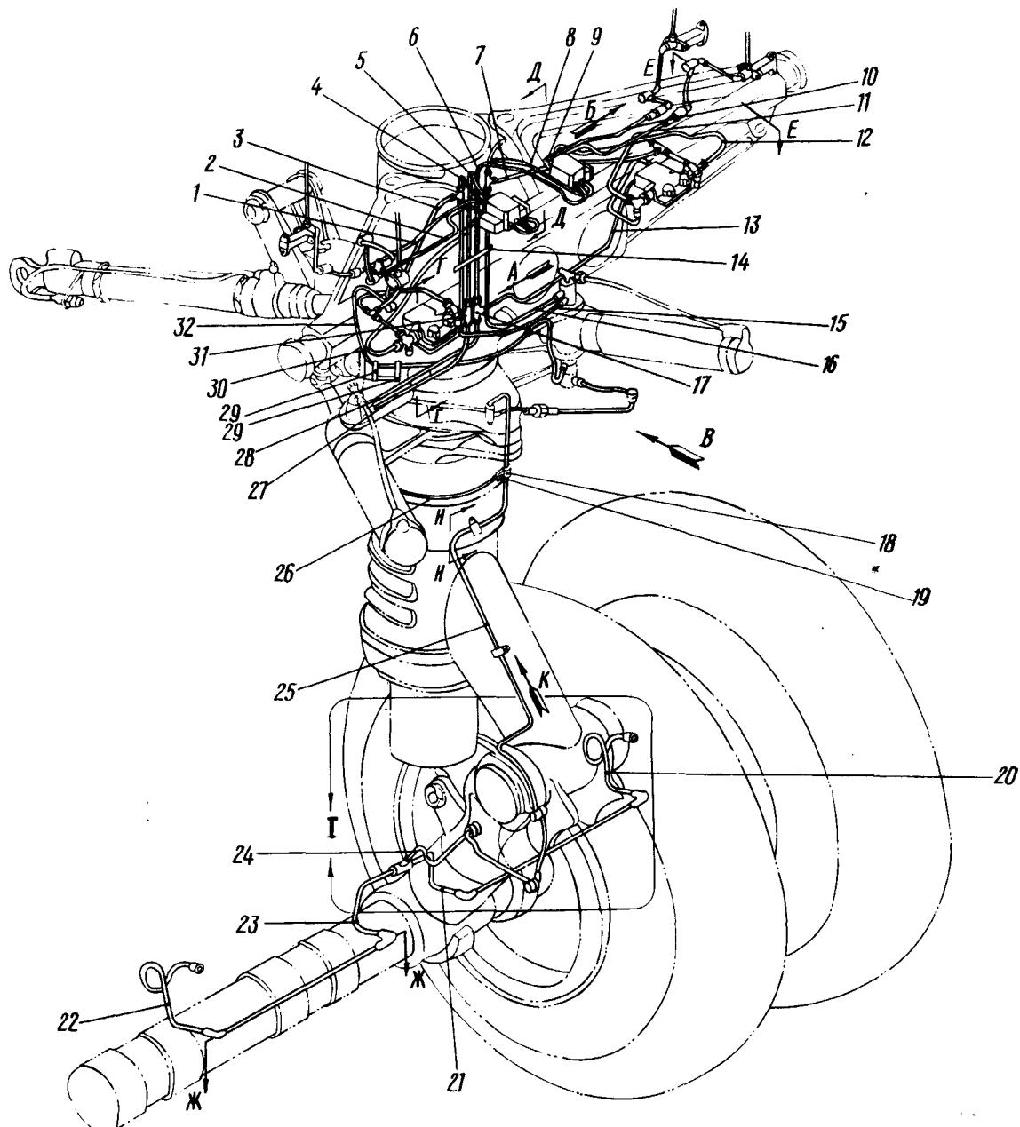
Проводка трубопроводов к цилиндру поворота носового шасси
