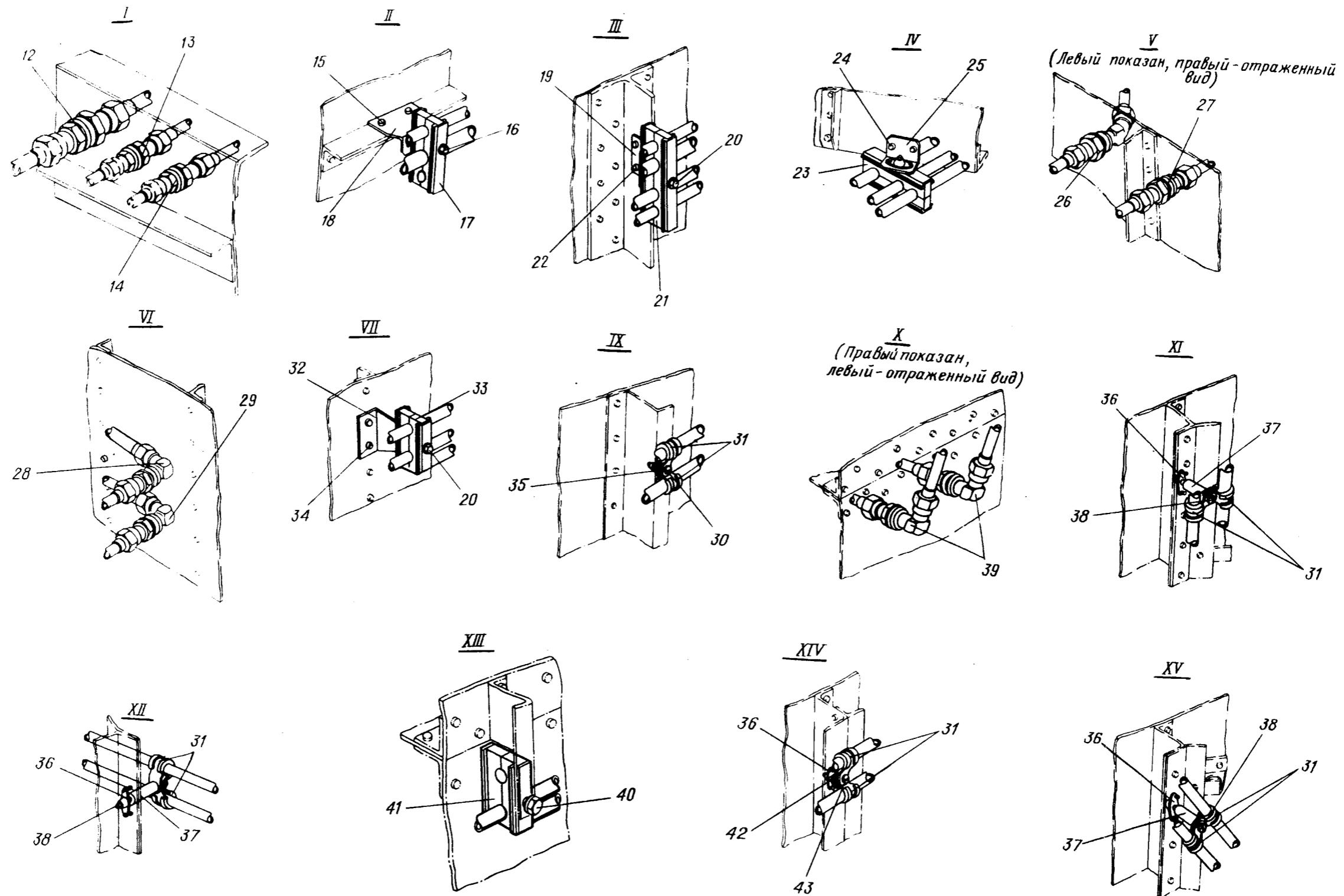
Гидросистема в отсеке носовой ноги шасси
