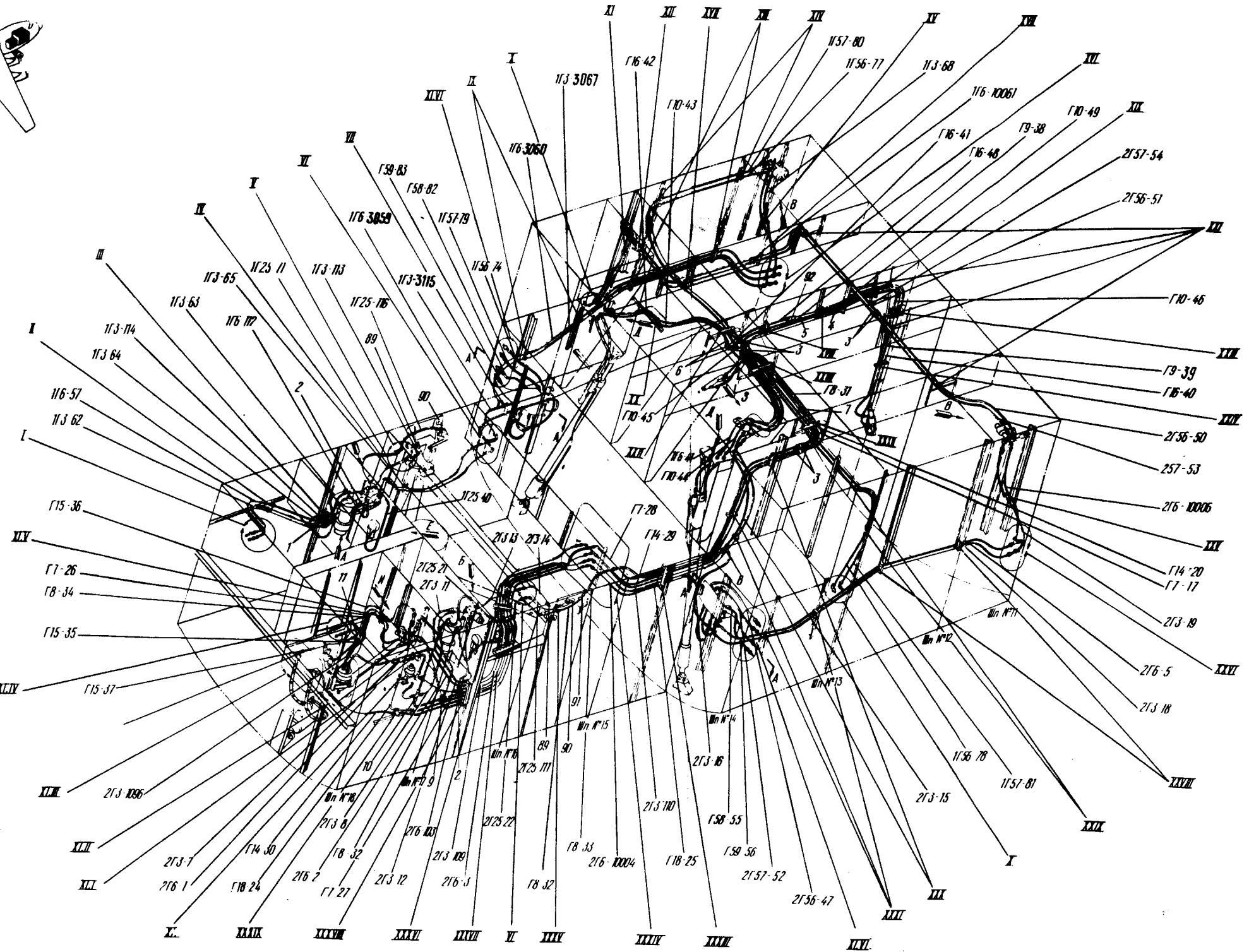
Гидросистема в отсеке носовой ноги шасси
