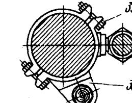
Гидроцилиндр больших створок отсека носовой ноги шасси
