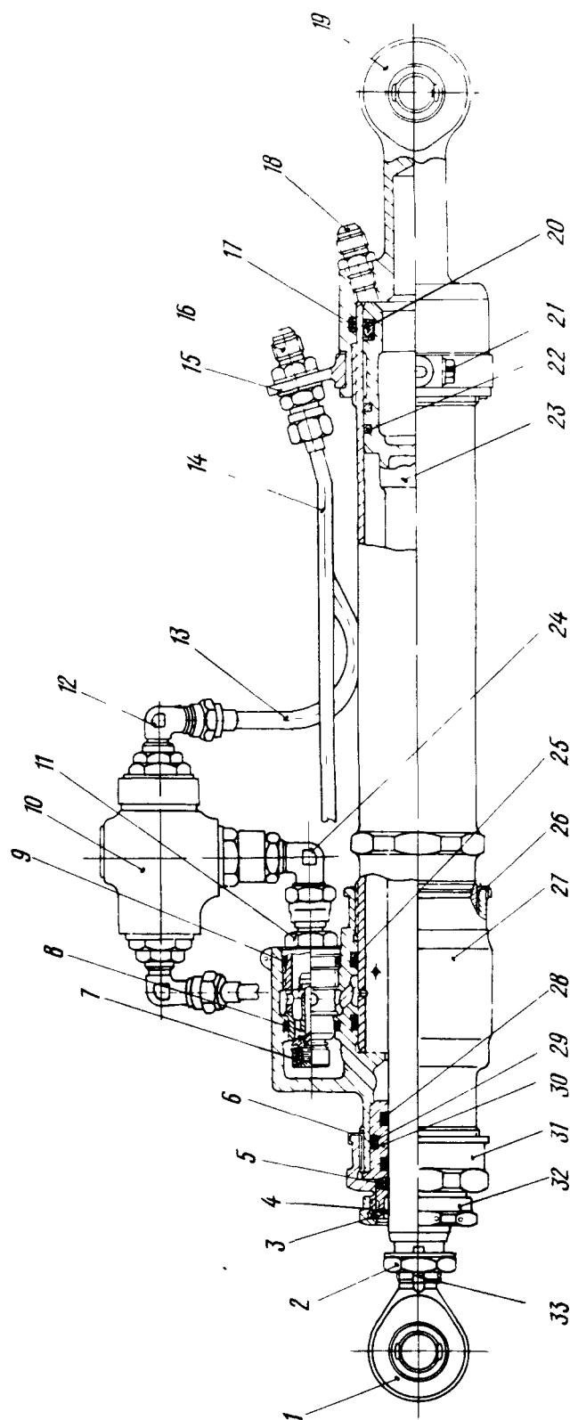
Гидроцилиндр больших створок отсека главной ноги шасси
