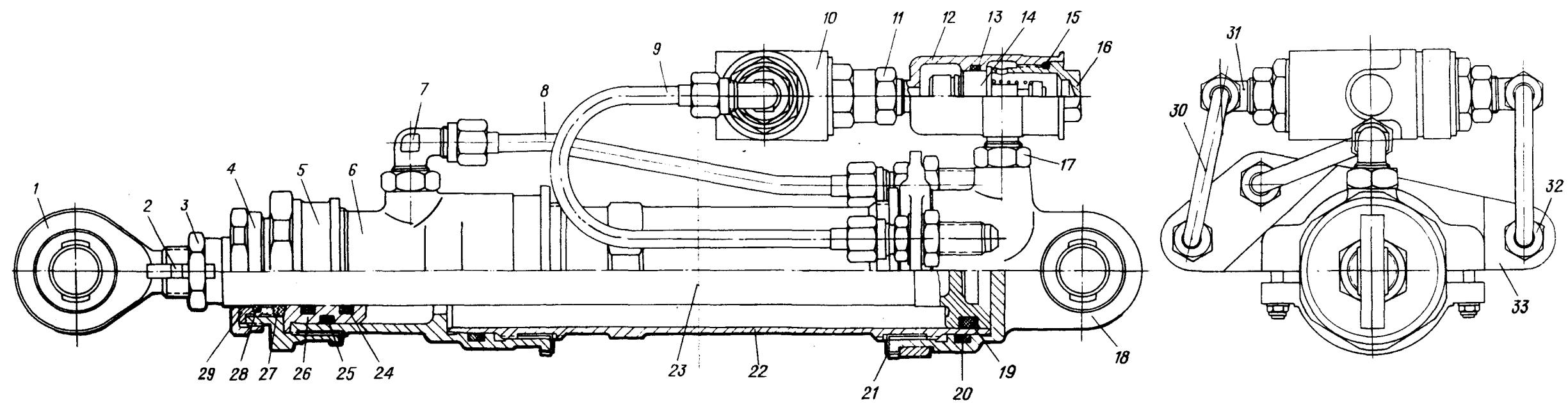
Гидроцилиндр складывающегося подкоса
