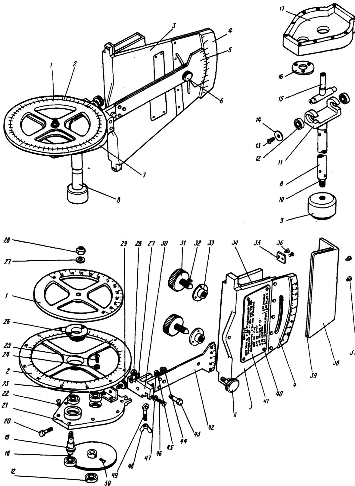
Прибор для замера углов отклонения
