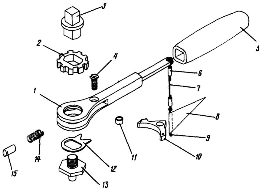
Ключ для отстопаривания управления переднего шасси
