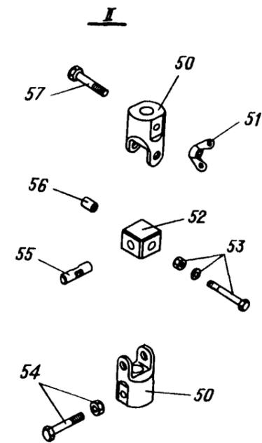
Приспособление для ручного привода предкрылков
