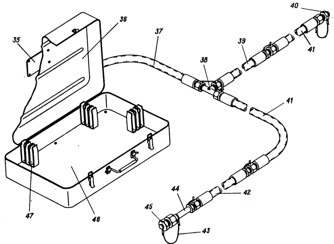
Приспособление для проверки высотной системы
