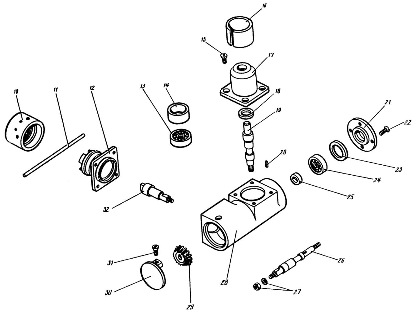
Приспособление для ручного привода закрылков
