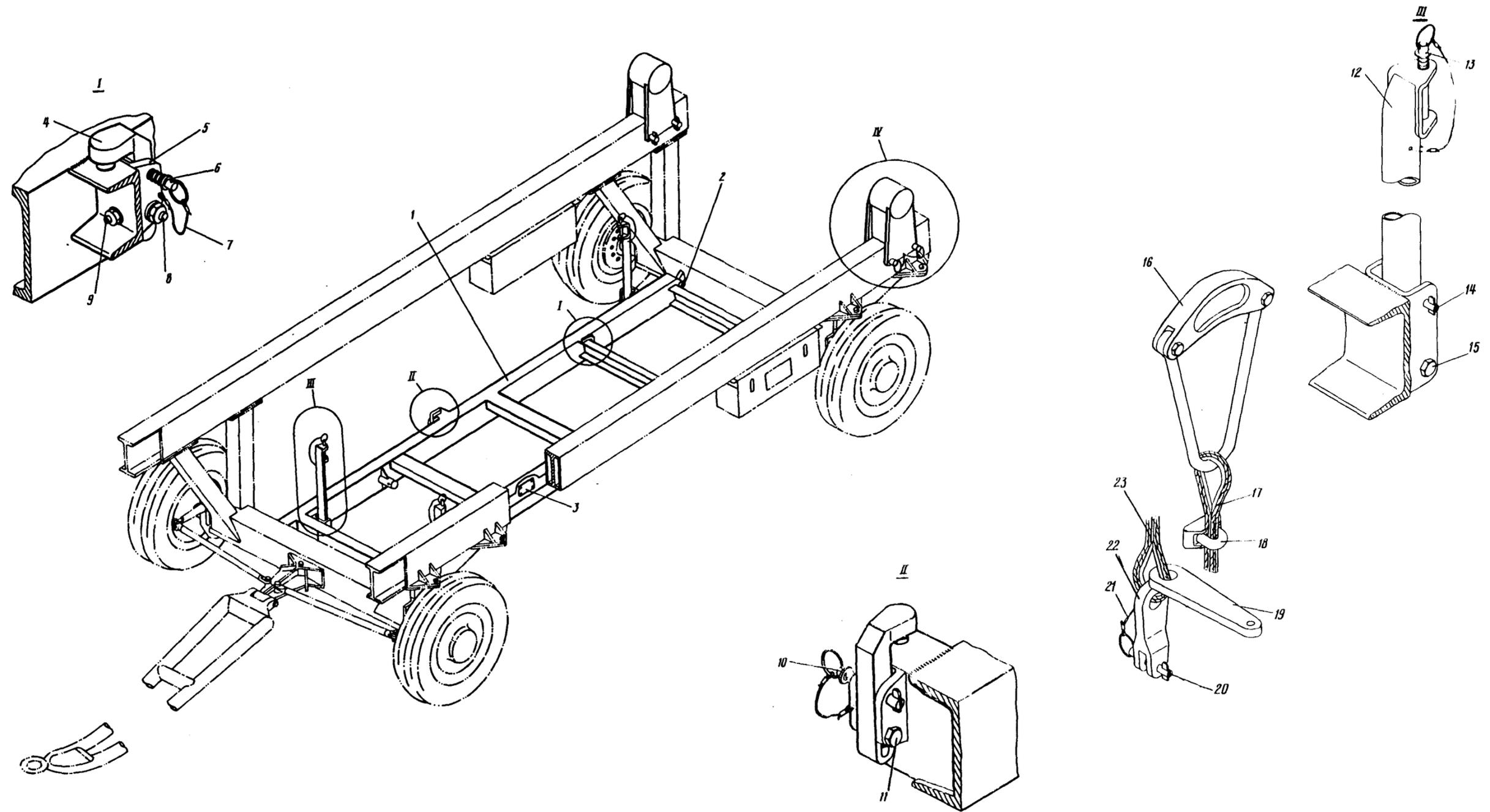
Приспособление для перевозки двигателя ТА-6А, ГНГ и шасси
