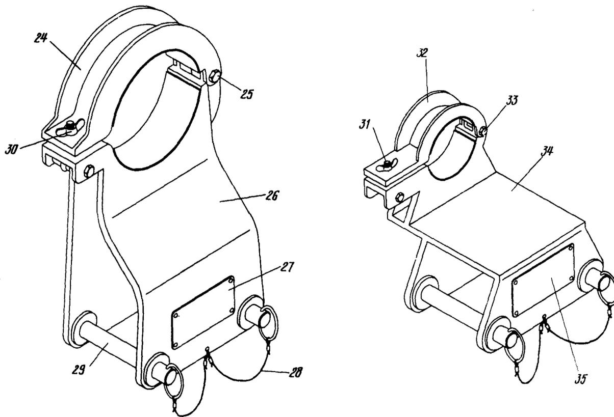
Приспособление для перевозки двигателя ТА-6А, ГНГ и шасси
