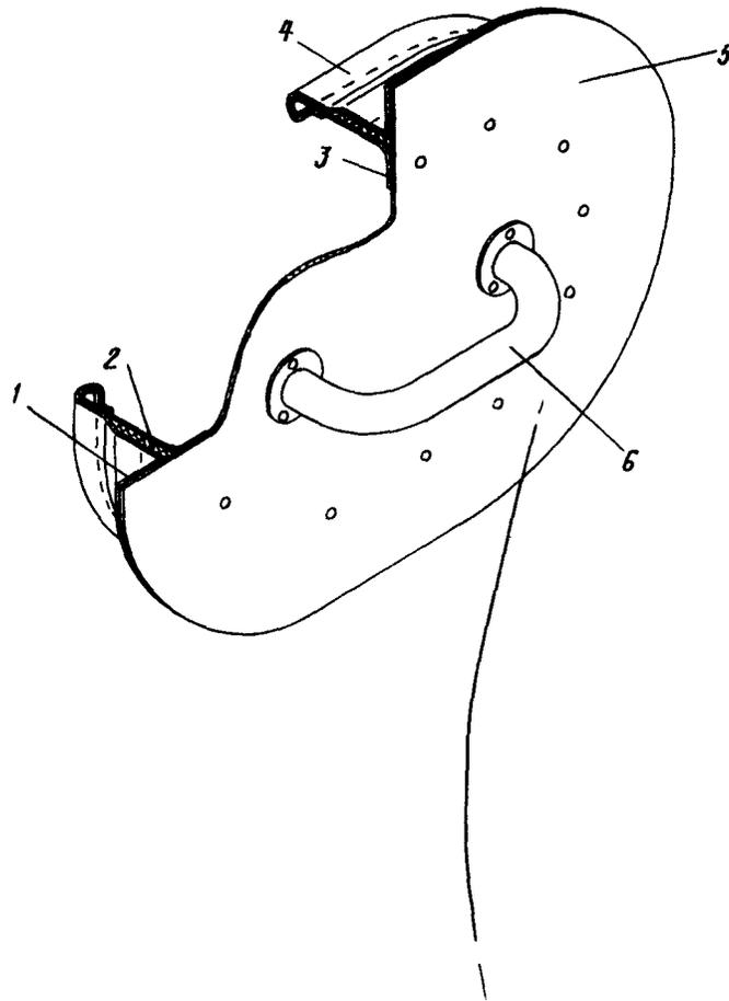
Заглушка на выхлопной патрубок двигателя ТА-6А
