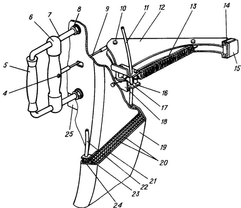
Заглушка выхлопной трубы двигателя
