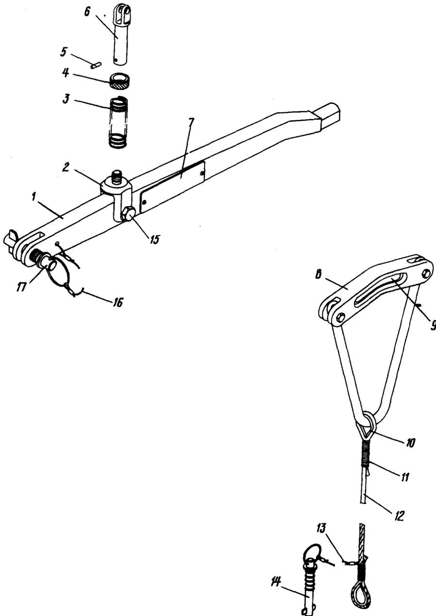
Приспособление для подъема турбоагрегата двигателя ТА-6А
