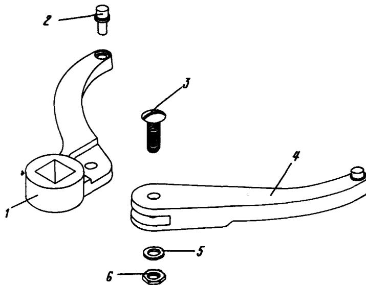
Ключ для гаек трубопроводов высотной системы
