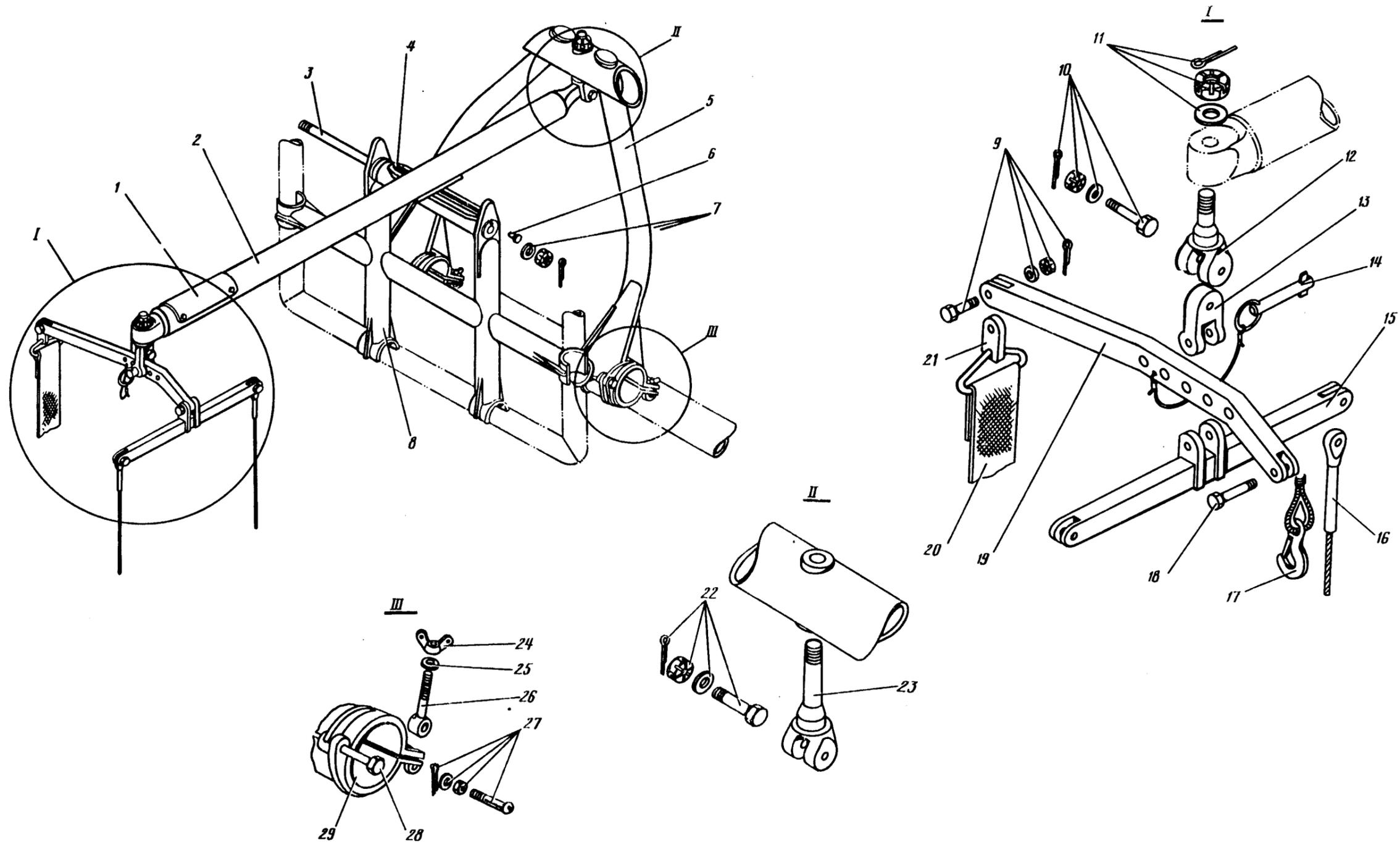
Приспособление для монтажа и демонтажа лебедки ЛПГ-3000А
