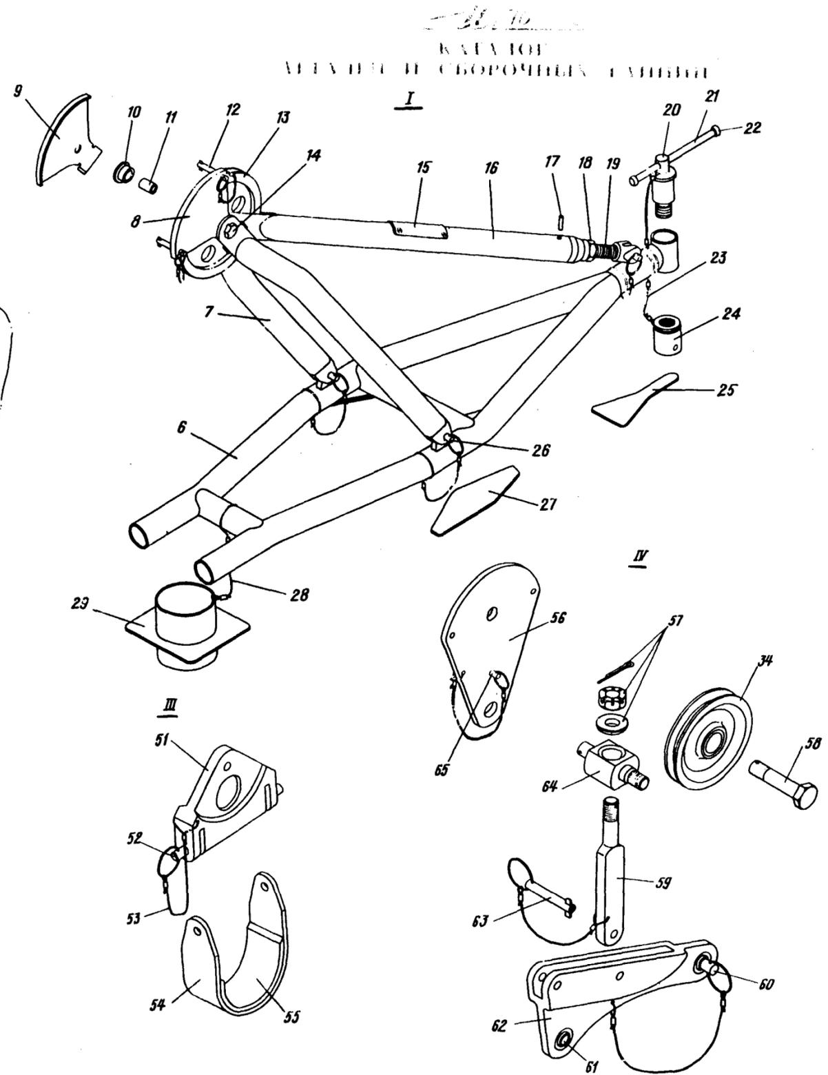
Приспособление для установки стоек шасси
