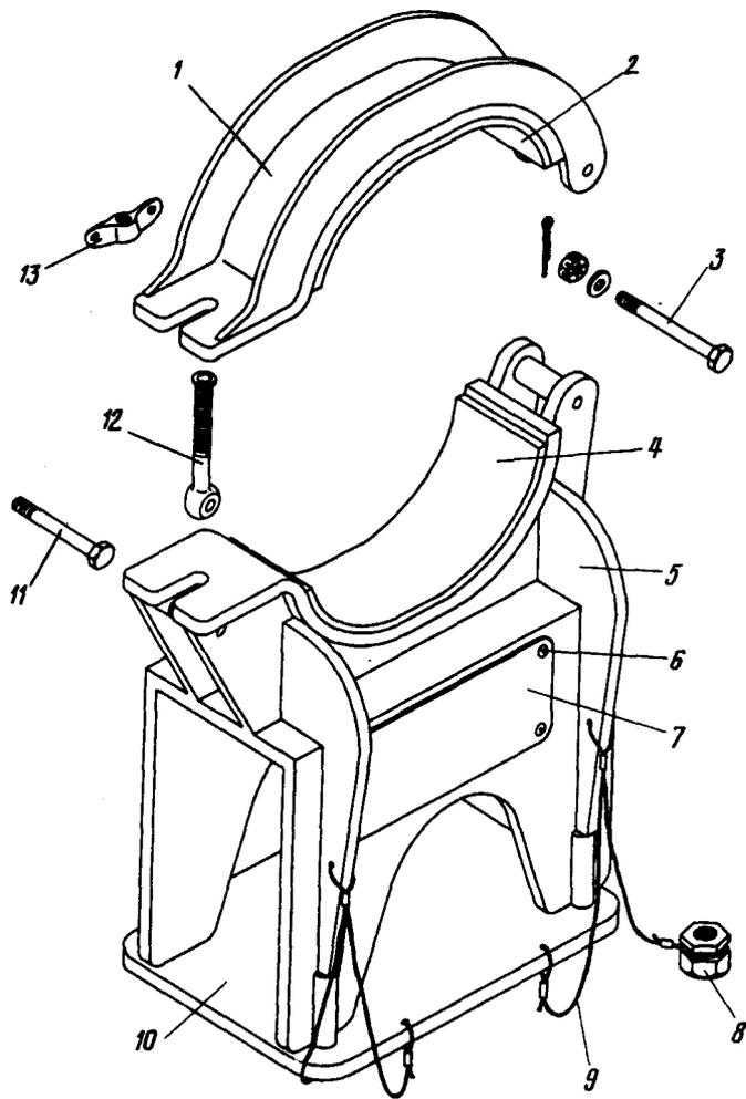
Дожемент для транспортировки стоек шасси без колес
