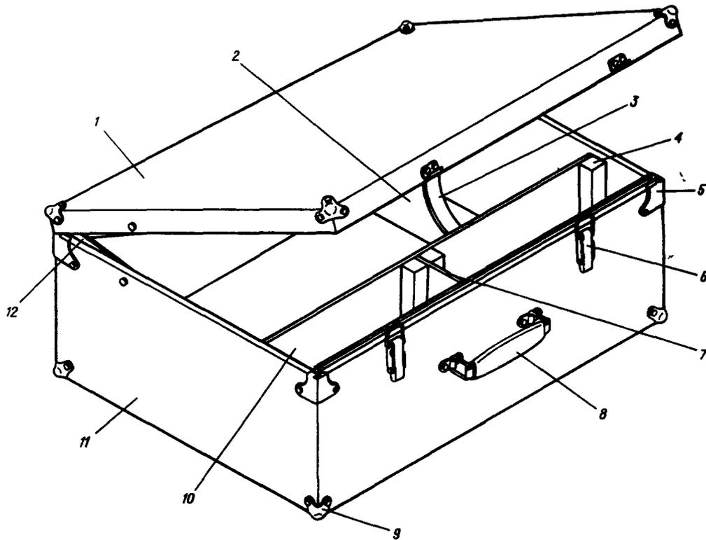
Ящик переходника для заправки топлива под давлением
