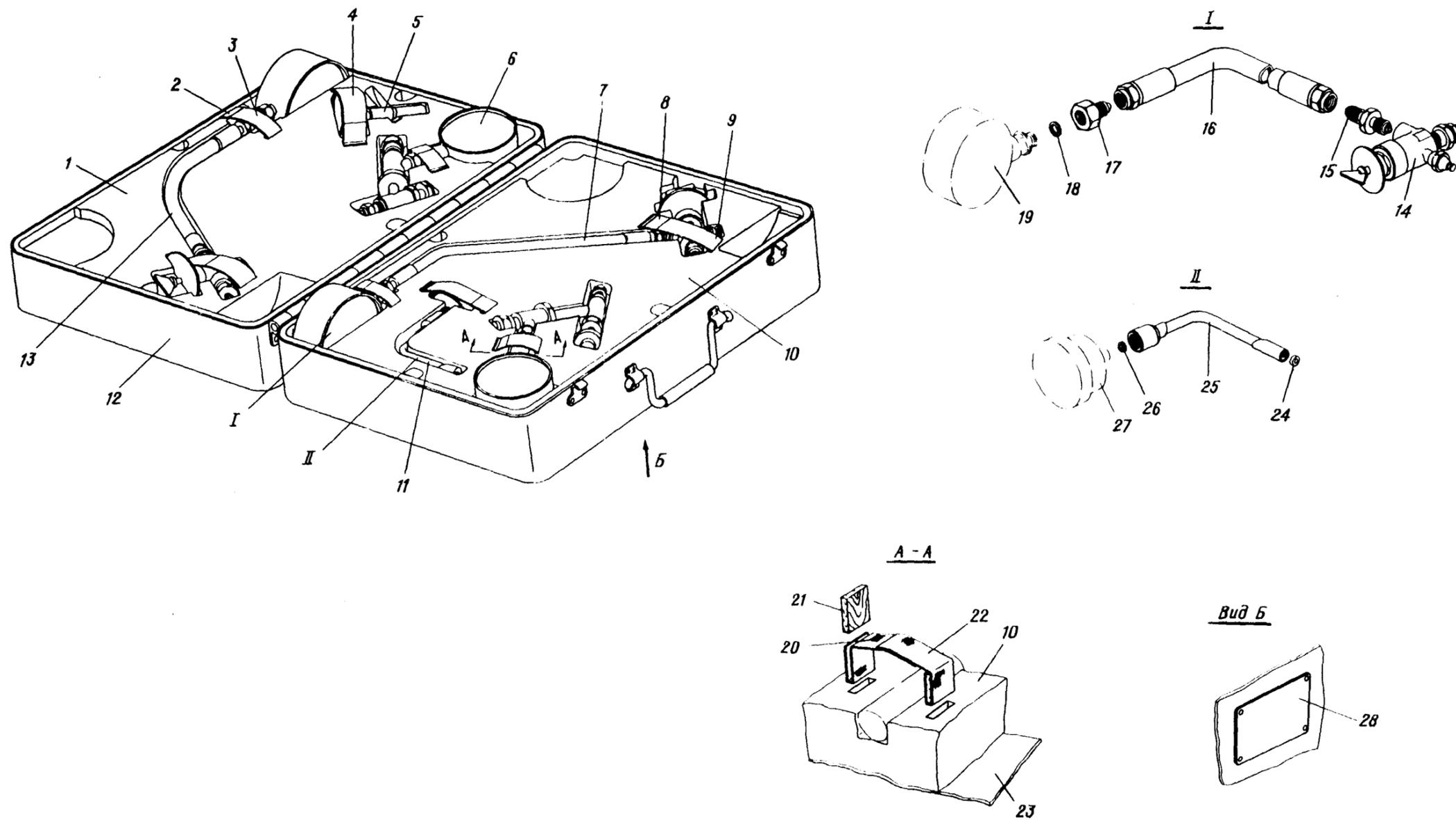
Установка приспособлений для проверки гидрогазовых систем
