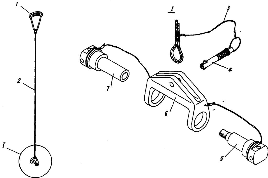
Строп двухприводного подъемника
