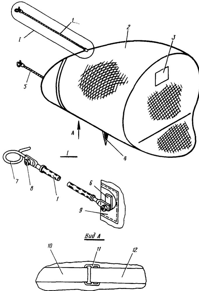
Заглушка на выхлопную трубу двигателя
