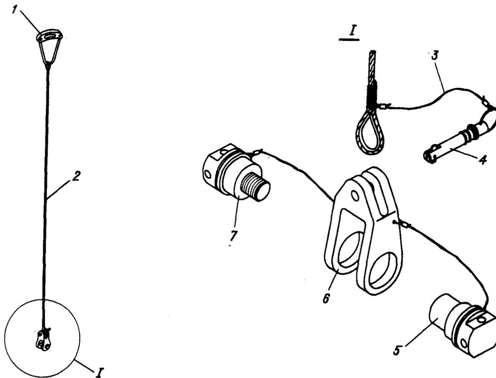
Строп для подъема подъемника стабилизатора
