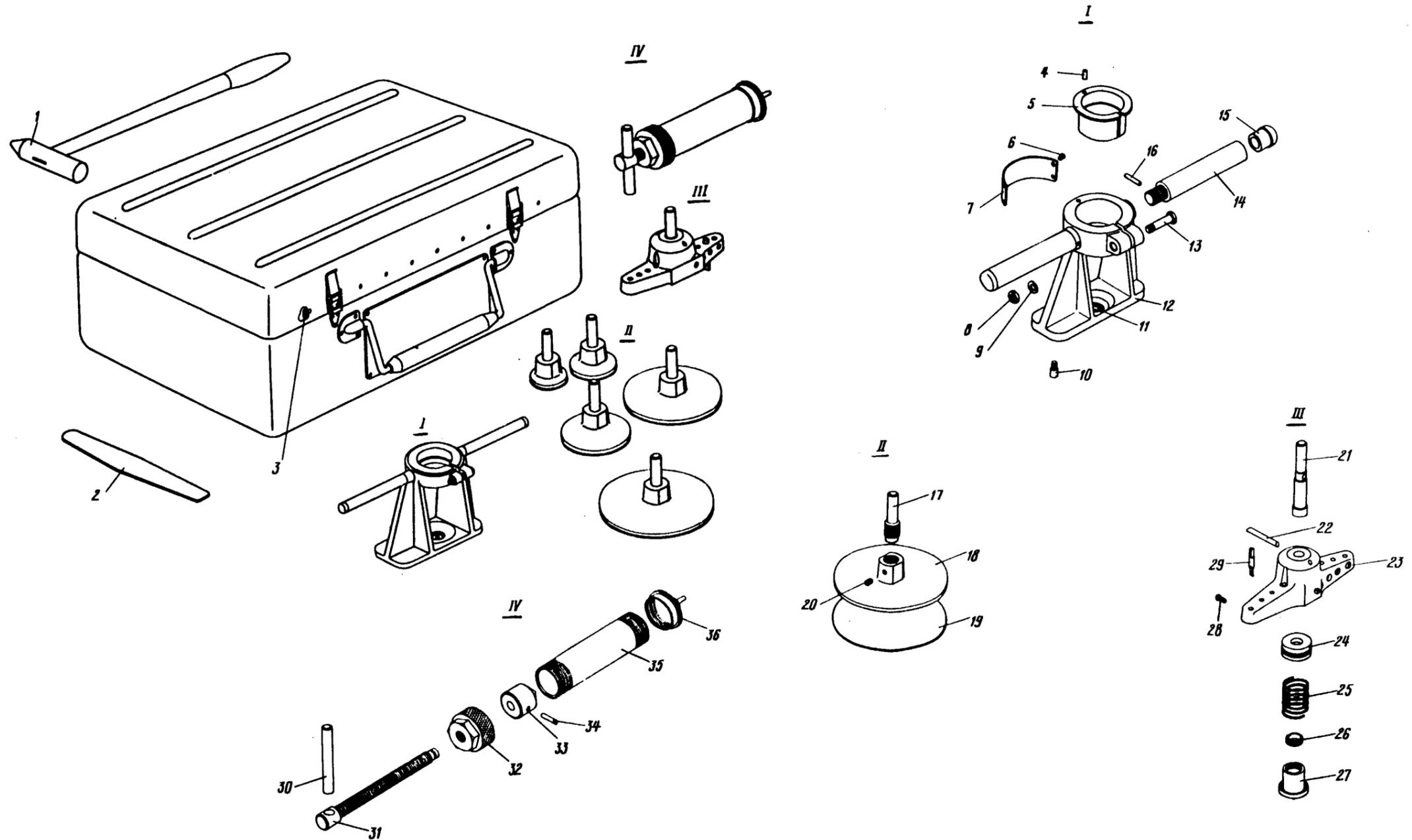
Чемодан для ремонта агрегатов сотовой конструкции
