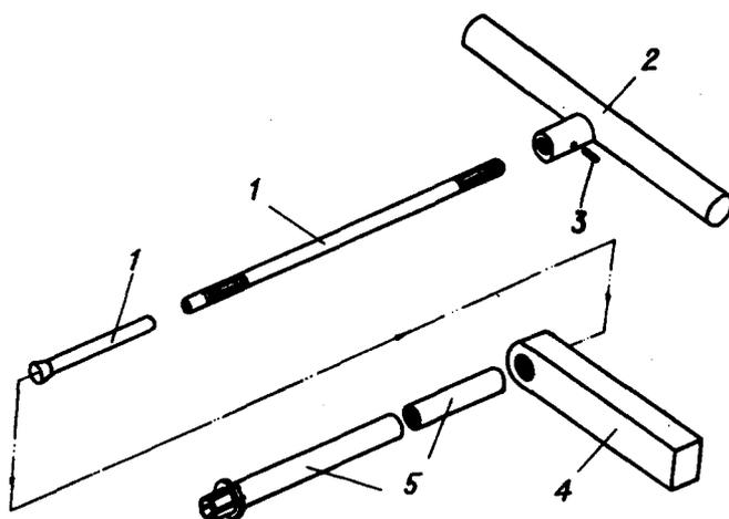
Приспособление для монтажа трубки
