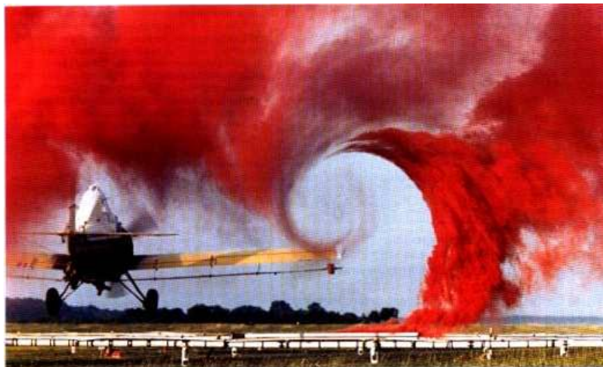
Abb. 6-5: Sichtbarmachung der freien Wirbel an einem Landwirtschafts-Sprühflugzeug
