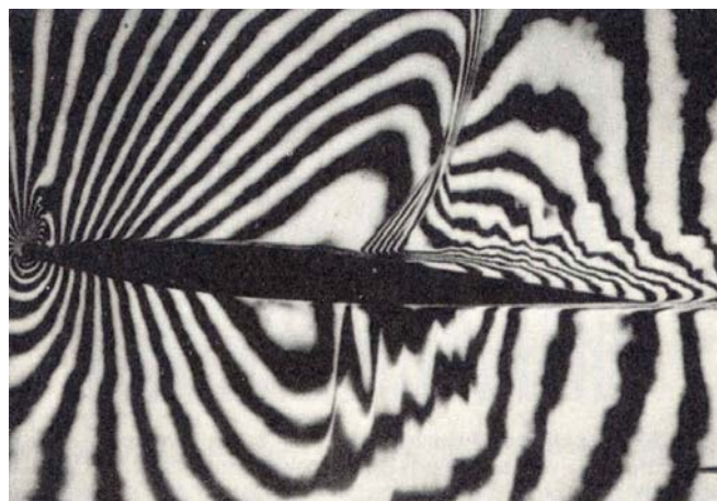
Abb. 8-6: Interferogramm einer Überschallströmung um ein Profil [ 13]
