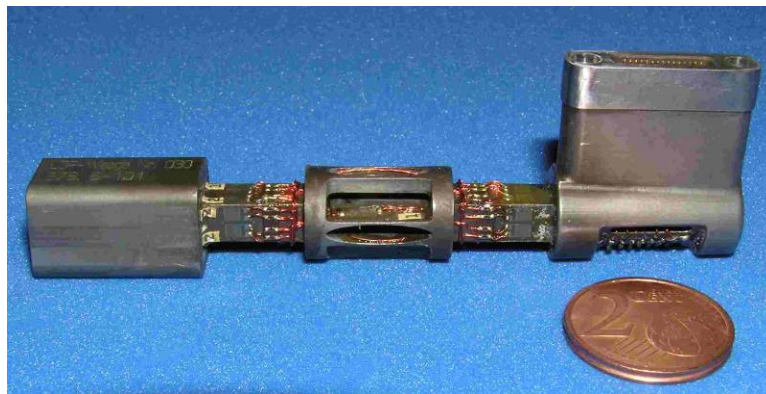
Abb. 2-18: EADS Außenlastwaage für das Modell (1:15) einer Luft-Boden-Waffe,
