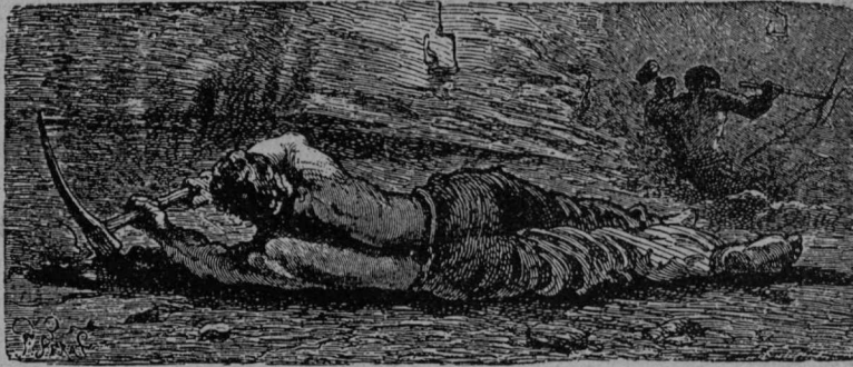
Ручная забойка в тонком пласте.
