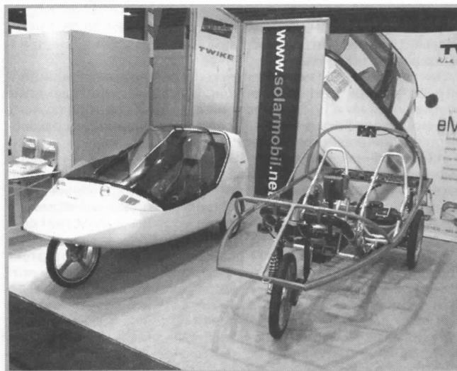
Транспорт будущего для людей нынешних представила компания BSM (Bundesverband Solare Mobilität). Jetcar построили братья Кристиан и Михаэль Венгеры, заменив дизель на электромотор мощностью 8 кВт.
