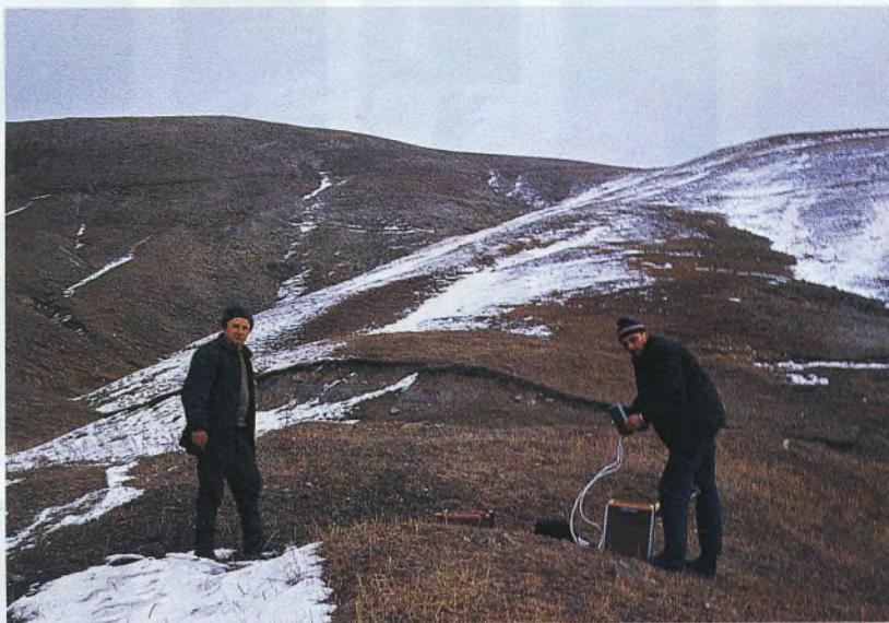
Установка акселерографа (измерителя ускорения движения почвы при землетрясении) в эпицентralной зоне землетрясения в Спитаке.
