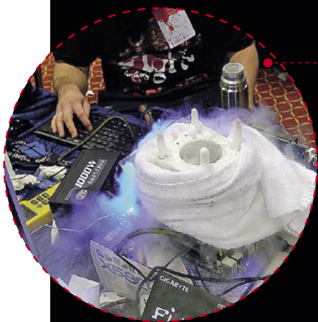
Процессоры всех тестовых стендов охлаждались жидким азотом. Каждый участник привез на соревнования свой стакан для этого хладагента
