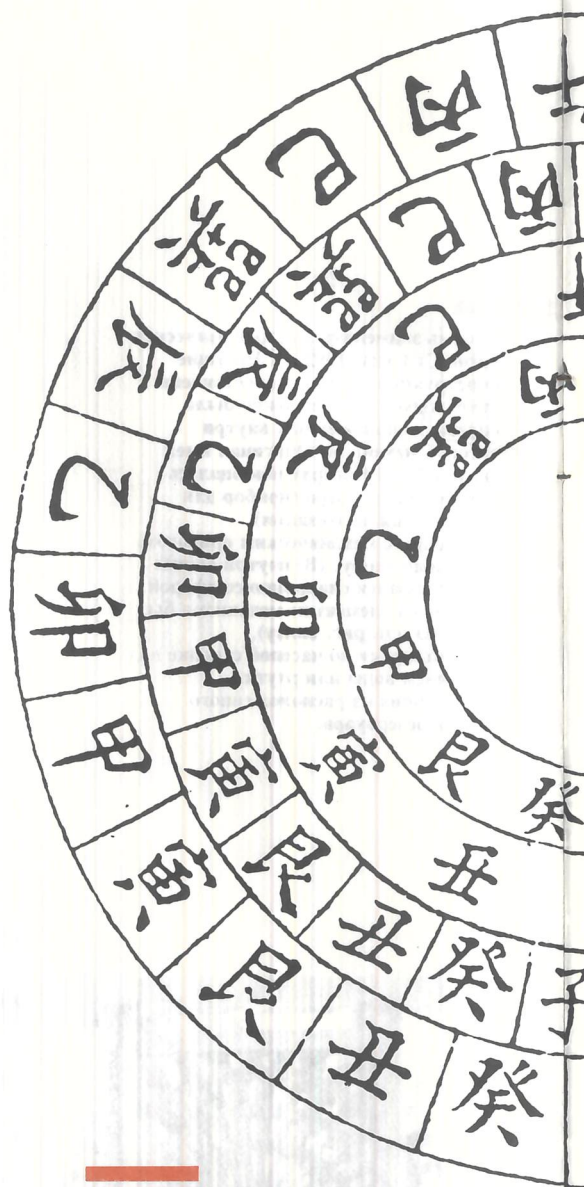
Эта диаграмма говорит о том, что магнитное склонение было известно китайским ученым в глубокой древности. Она взята из трактата о геомагнитных полях «Направления и эманации плавающей иглы» (начало X в.), то есть иглы компаса, плавающей в воде или ртути.
